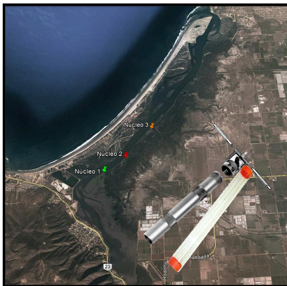
Fig. 5. Obtención de los tres núcleos sedimentarios con un nucleador manual Wildco.
