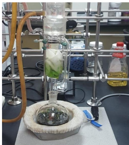
Figura 6. Extracción de hoja de higuera en Soxhlet.
