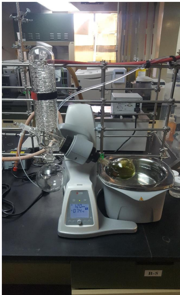
Figura 14. Concentración de extracto en rotaevaporador.
