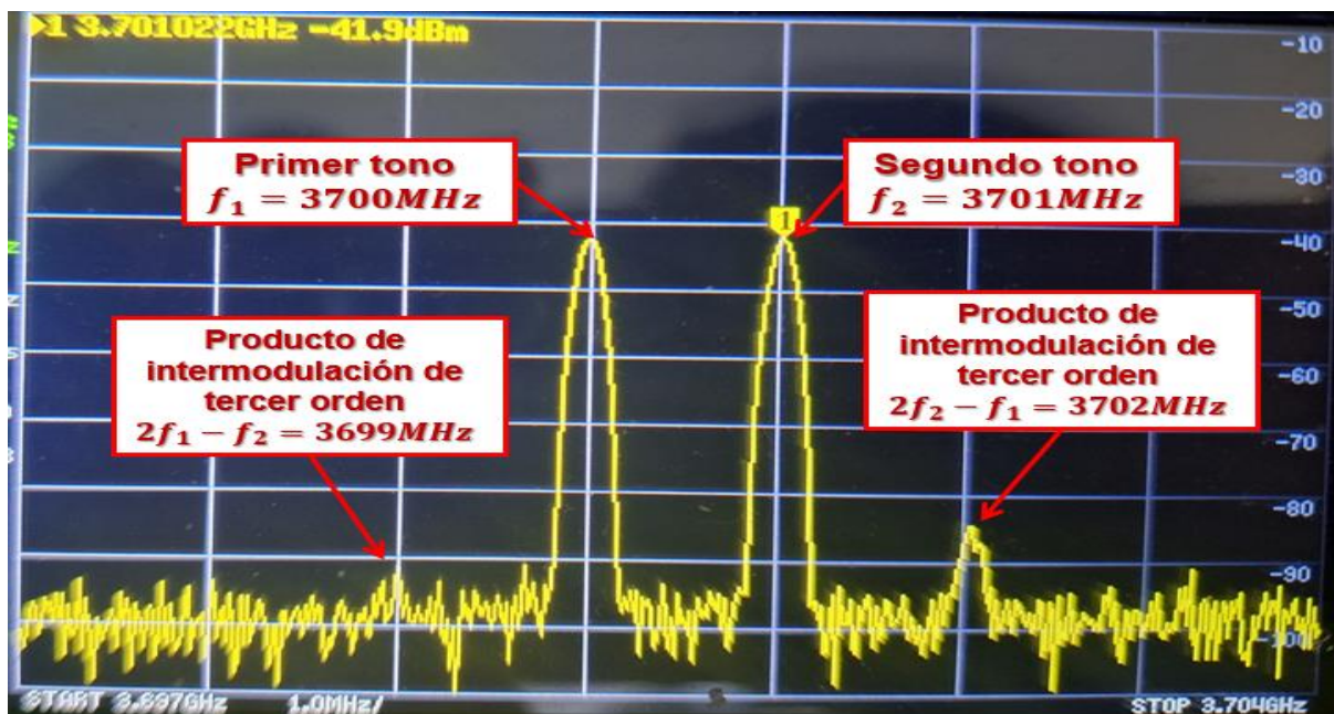
Figura 4.6– Captura del espectro con analizador mostrando los dos tonos de la señal y los respectivos productos.
