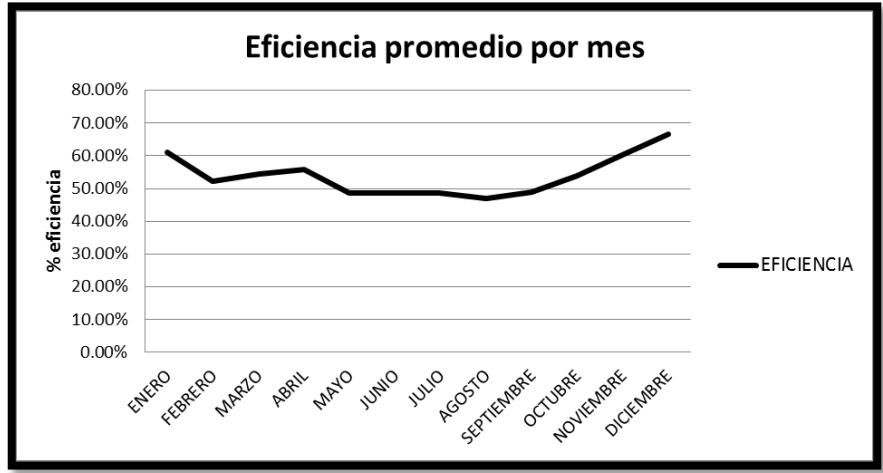
Figura 9.1. Eficiencia del CSA dado para Mexicali con orientación sur e inclinación de 25 grados.
