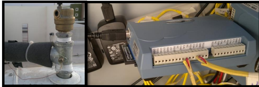
Figura 5.7. Sistema de adquisición de datos LogicBus, y termopar en válvula.
