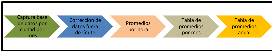
Figura 5.1. Procesamiento de datos meteorológicos.
