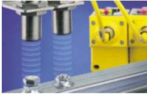
Fig. 2. 19 Detección de tornillos mal ajustados con sensor ultrasónico
