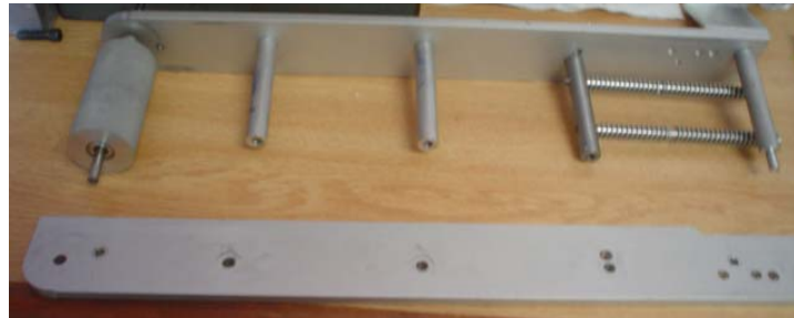
Fig. 3.12 Armado de estructura para banda transportadora
