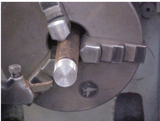
Fig. 3. 5 Careado de pieza.
