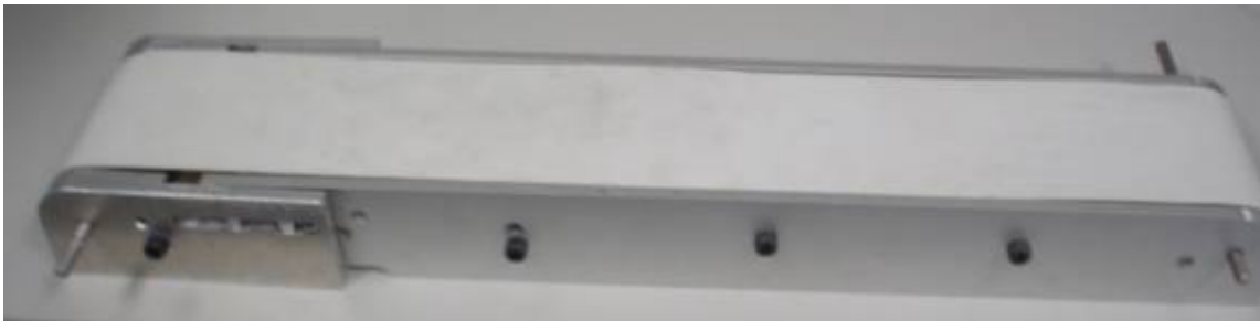
Fig. 3. 20 Sistema de banda transportadora
