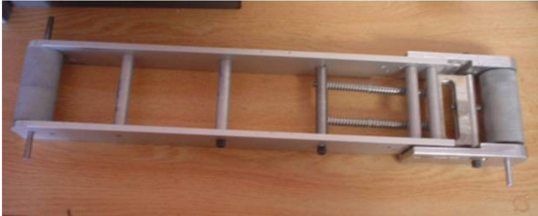
Fig. 3. 19 Estructura de banda transportadora
