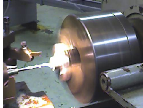
Fig. 3. 7 b) Barrenado con broca de 1/8"
