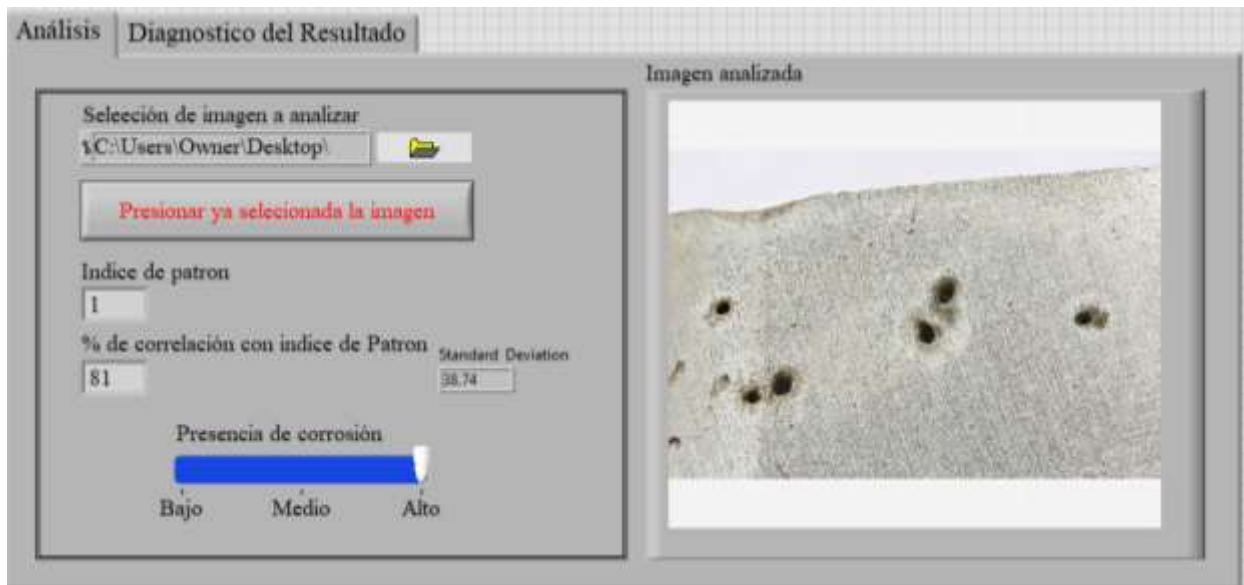
Figura 47. Panel frontal de instrumento virtual, pestaña de Análisis.
