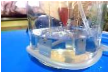
Figura 37. Prueba por inmersión para aluminio con corrosión uniforme, recipiente con aeración
