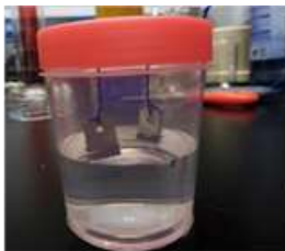
Figura 42. Prueba por inmersión de muestras de acero con corrosión uniforme.
