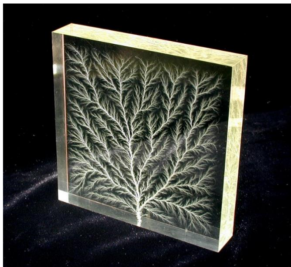
Figura 3. Figura de Lichtenberg producida por una descarga (Huang & Zhi, 2016).
