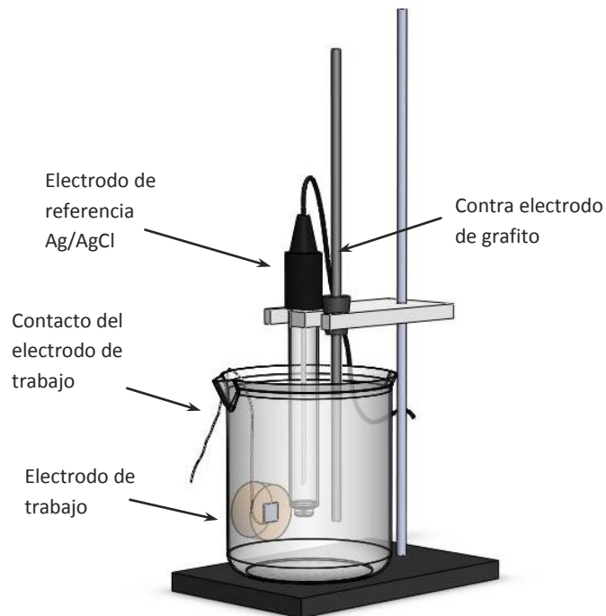
Figura 3-5 Celda electroquímica utilizada para los ensayos de corrosión para AA6061-T6 y m5-12.
