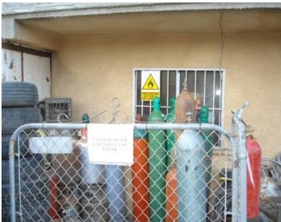
Figura 27 Después de las 5'S (almacén de sustancias inflamables).
