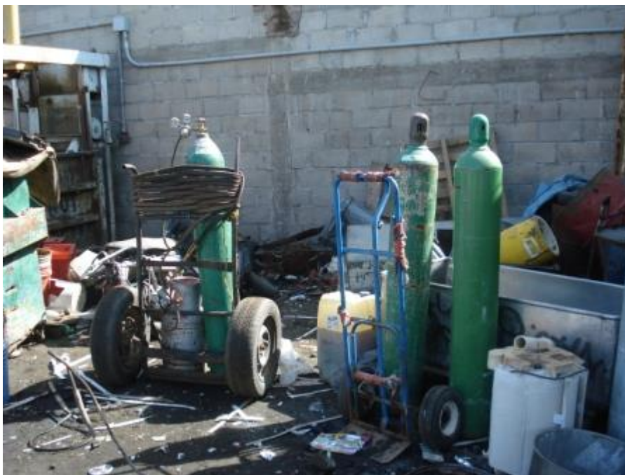
Figura 8 Muestra que no se cuenta con un lugar apropiado para el almacenaje de sustancias inflamables.
