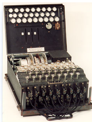
Figura 9: Máquina enigma usada por la Alemania nazi durante la segunda guerra mundial.
