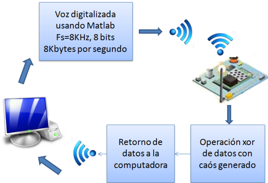
Figura 25: Diagrama de comunicación entre dispositivos a utilizar.
