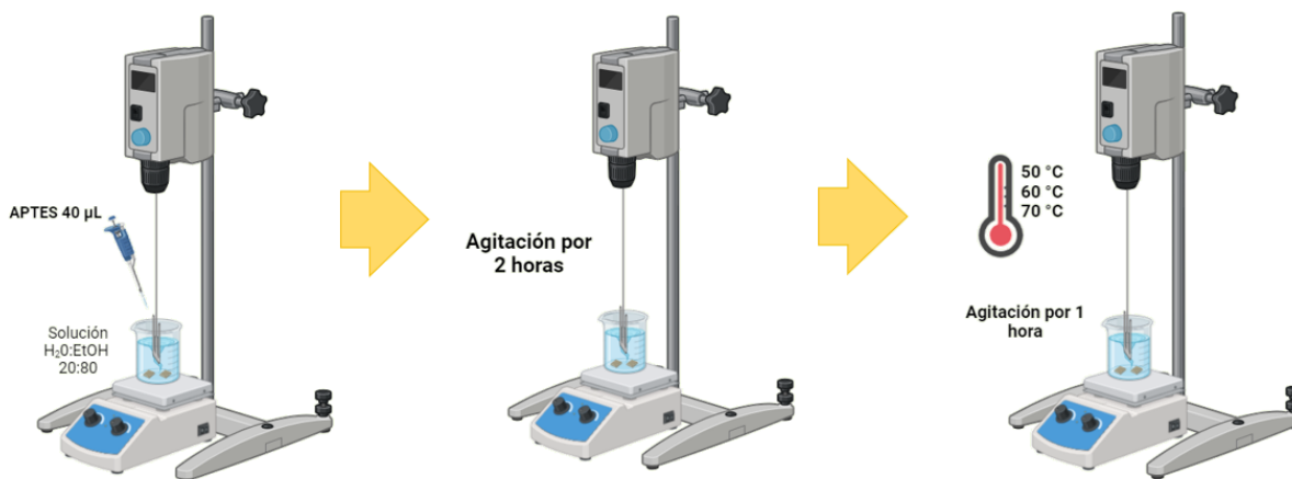
Figura 16. Esquema de síntesis de funcionalización de sustratos de silicio con APTES.
