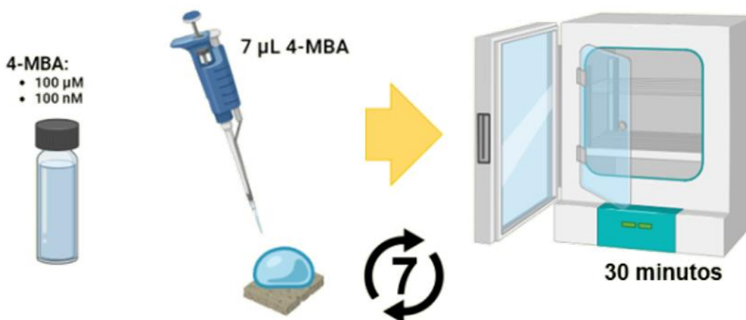
Figura 18. Esquema de síntesis de incubación de sustratos de Si en soluciones etanólicas de 4-MBA.
