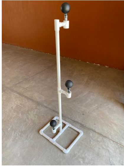
Figura A12. Prototipo final para mediciones de globo negro. Fuente. Fotografía tomada por el autor
