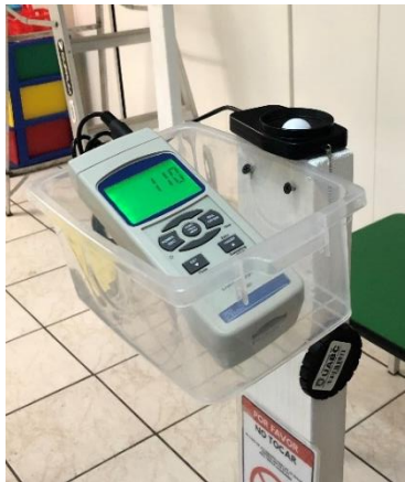
Figura A5. Luxómetro colocado en pedestal. Figura A6. Sensor de CO^2 colocado en pedestal.
