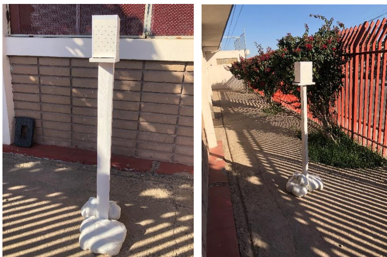
Figura A8, A9. Primera posición de instrumento para TBS y HR exterior. Fuente. Fotografías tomadas por el autor.
