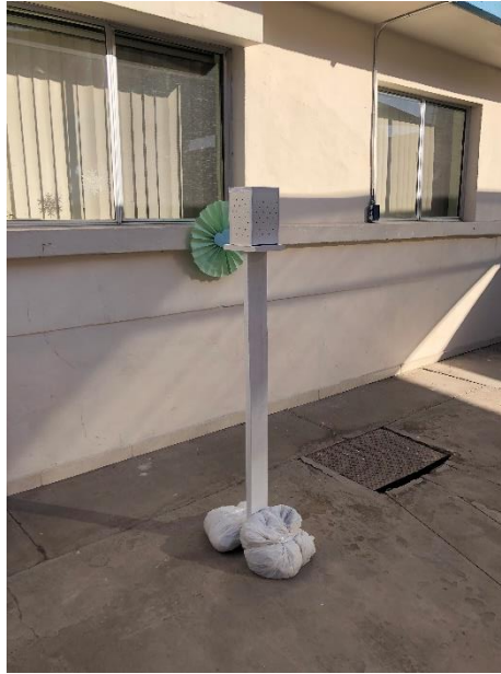
Figura A10. Posición final de instrumento para TBS y HR exterior. Fuente. Fotografía tomada por el autor
