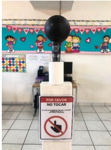
Figura A4. Sensor de globo negro colocado en pedestal. Fuente. Fotografía tomada por el autor
