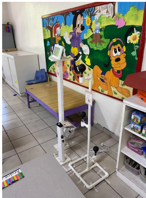
Figura B6. Instalación final de sensores de iluminancia, CO_2 y T_r , preescolar B Fuente. Fotografía tomada por el autor
