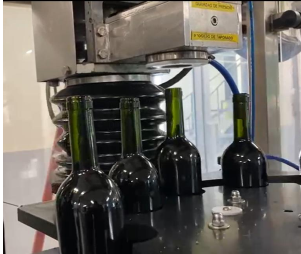
Figura 7. Proceso de taponado de botella.
