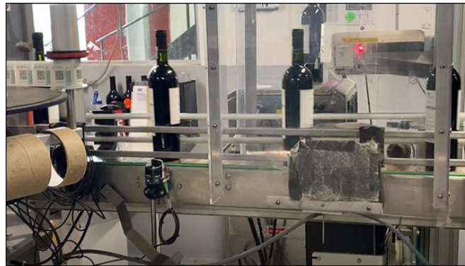
Figura 11. Proceso de codificado de botellas.
