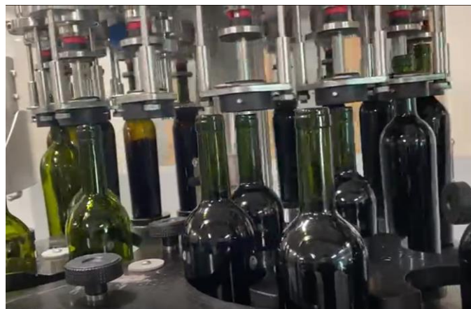
Figura 6. Proceso de llenado de botellas
