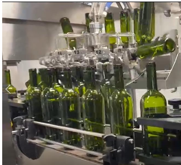
Figura 5. Proceso de lavado de botella.
