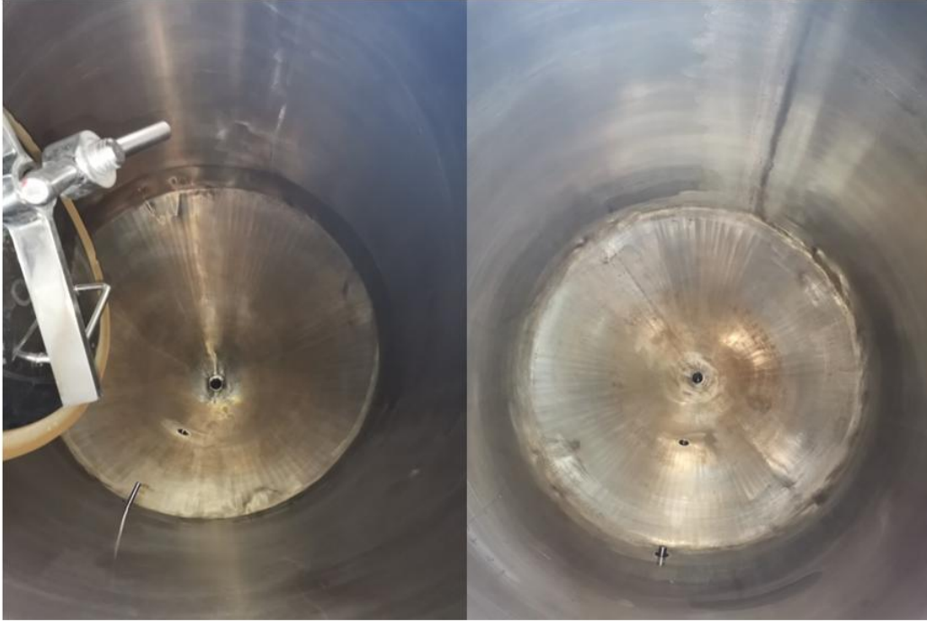
Fermentador y abrillantamiento antes del proceso de pasivado.
