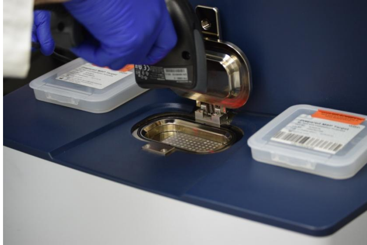
Colocado y lectura de placa para iniciar secuencia del equipo MALDI Biotyper
