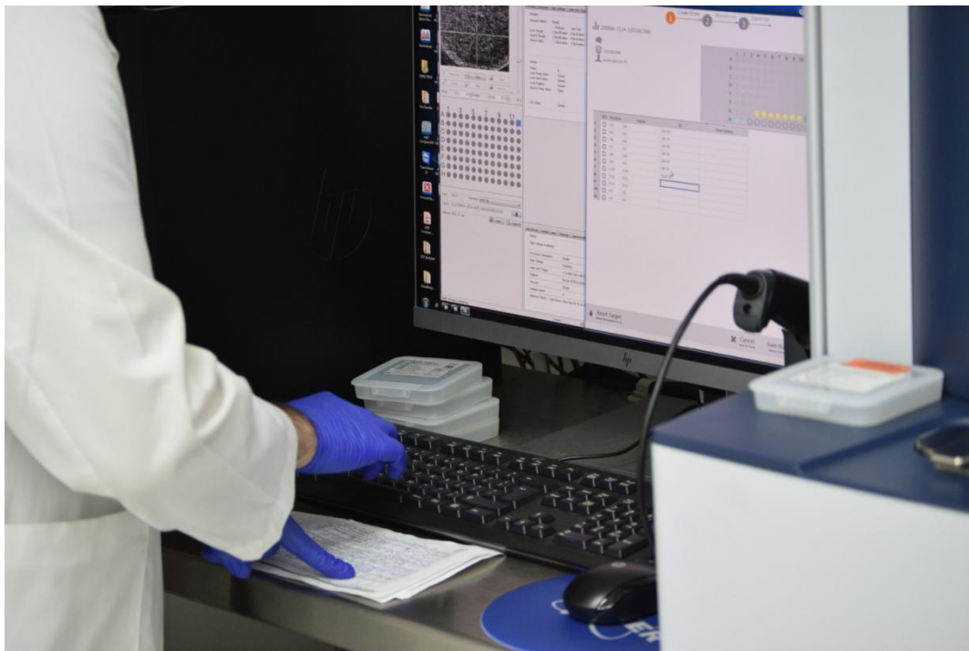
Configuración y lectura de muestras en placa MALDI
