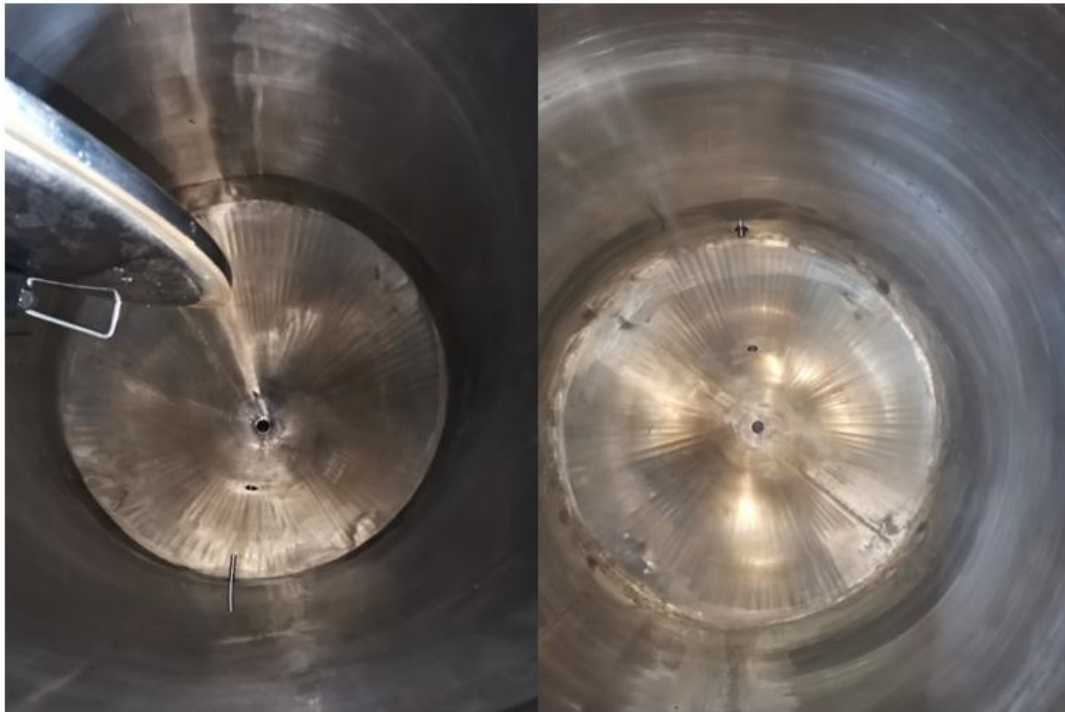
Fermentador y abrillantamiento despues del proceso de pasivado, sin oxidar.
