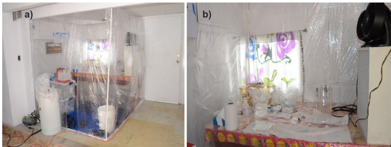
Figura 7. (a) Cuarto limpio construido en Bahía de los Ángeles a base de tubería de PVC y paredes de plástico. (b) Interior del cuarto limpio equipado con mesa de trabajo y campana de flujo laminar con filtro HEPA. Esta campana inyecta aire limpio al cuarto, manteniendo una presión positiva y, en consecuencia, una atmósfera libre de partículas contaminantes.
