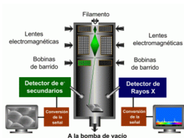
Figura 24. Esquema operativo de un microscopio electrónico de barrido con detector EDS.
