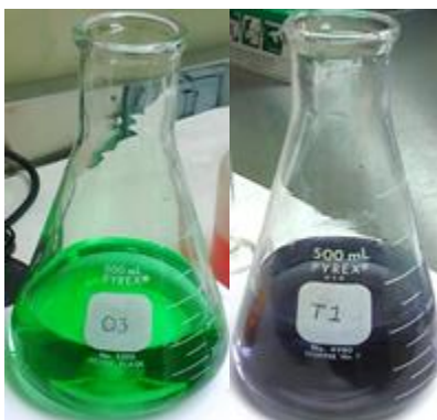
Figura 10. Cambio de coloración en la solución destilada por titulación con HCl 0.1N.
