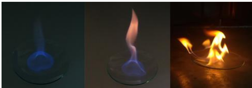
Figura 19. Combustión de bioetanol de mezquite (izquierda), alcohol comercial (centro) y gasolina (derecha).
