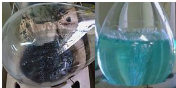
Figura 8. Muestra de mezquite carbonizada a 130°C y cambio de coloración con aumento gradual de temperatura.
