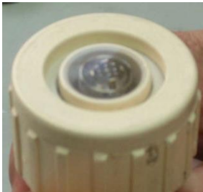
Figura 24. Vista del sensor listo para ser utilizado. Debajo de la membrana transparente se encuentra el multielectrdo de paladio (trabajo), referencia (plata) y como una espiral alrededor, el electrodo auxiliar (platino).
