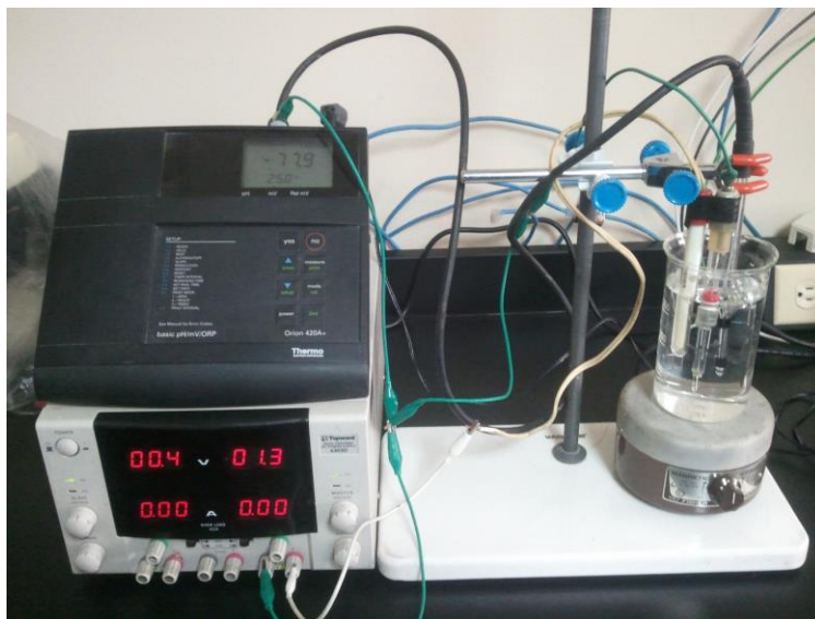
Figura 15. Equipo real aplicado para la caracterización del RHE
