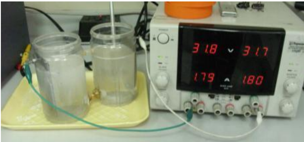
Figura 26. Celda utilizada para la generación de hidrógeno y calibración del sensor
