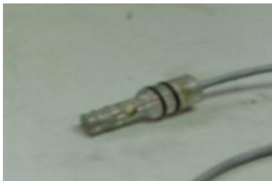
Figura 20. Cuerpo interno del Sensor Voltamétrico de Hidrógeno
