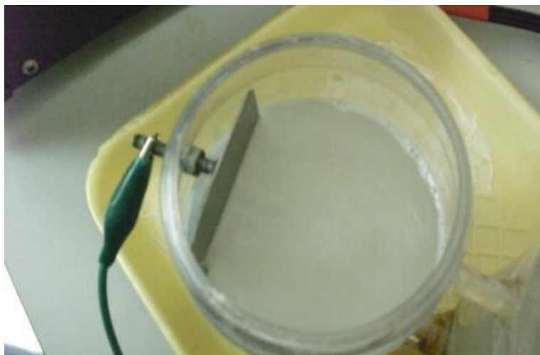
Figura 27. El hidrogeno generado forma burbujas en el compartimiento catódico
