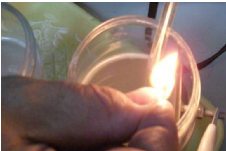
Figura 28. Naturaleza del hidrogeno generado en el compartimiento catódico comprobada por fuego
