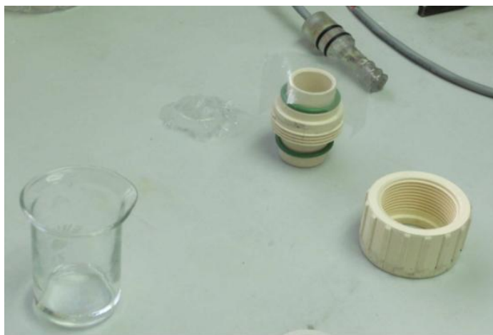
Figura 21. Componentes del Sensor Voltamétrico de Hidrógeno: Cuerpo de PVC, membrana de polietileno y ácido Clorhídrico
