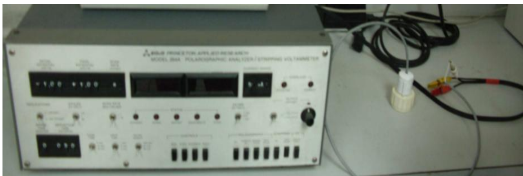
Figura 25. Vista del sensor voltamétrico conectado al equipo de medición.
