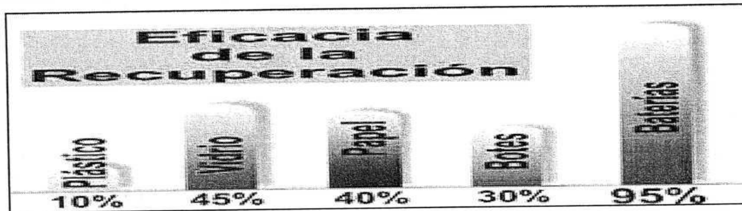
Figura 1.6. Eficiencia de recuperación de materiales.
