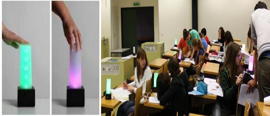
Figura 5. Uso de Lantern en el salón de clases. En la izquierda se muestra el dispositivo. En la derecha se observa cómo está distribuido el dispositivo en el aula, indicando en cual ejercicio se encuentra cada estudiante y cuanto tiempo lleva en él. Así, este sistema apoya la participación del estudiante mediante la asistencia oportuna de sus maestros, permitiéndole finalizar su actividad escolar con éxito.
