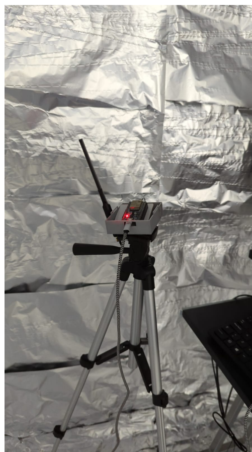
Figura 4.24: ESP32 que actúa como punto de acceso
