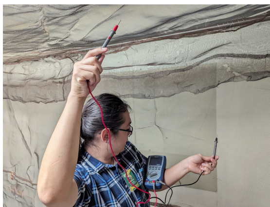
Figura 4.21: Medición de continuidad en la jaula
