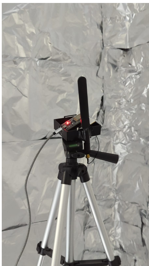
Figura 4.23: ESP32 que actúa como estación
