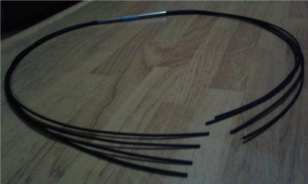
**Figura 45.** Acoplador de fibra óptica de plástico.
