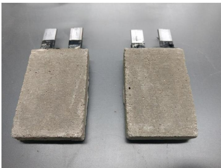
Figura 35. Muestras de mortero reforzado después de 7 días de curado
