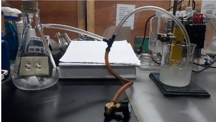
Figura 26. Carbonatación de solución saturada de  $\text{Ca(OH)}_2$
