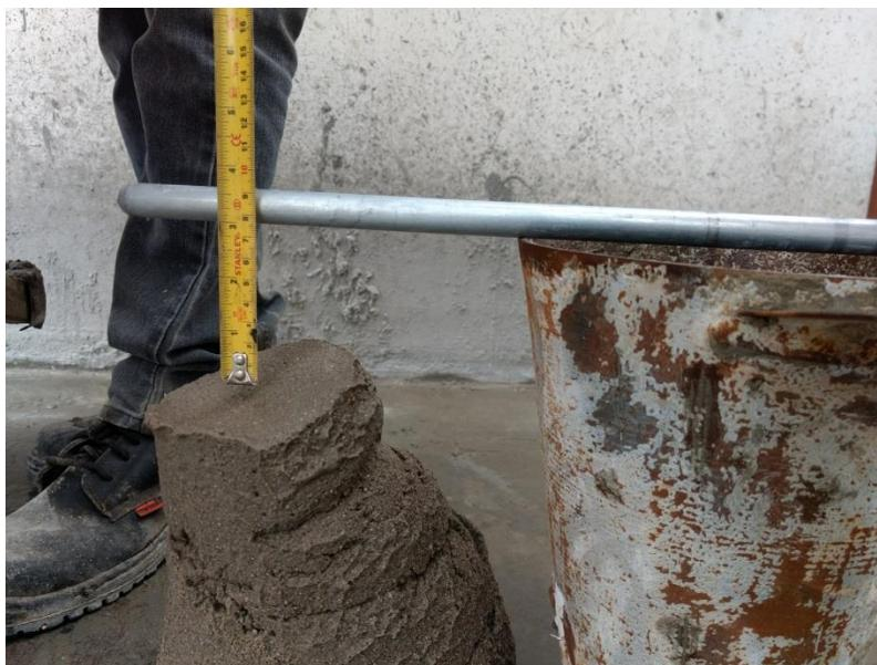
Figura 31. Prueba de revenimiento
