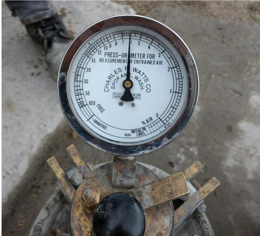
Figura 32. Prueba de contenido de aire
