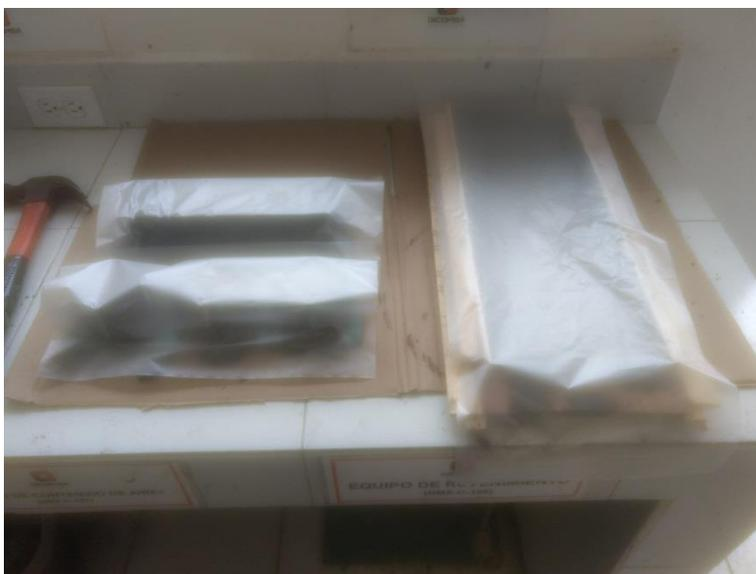
Figura 34. Condiciones de curado para muestras de mortero
