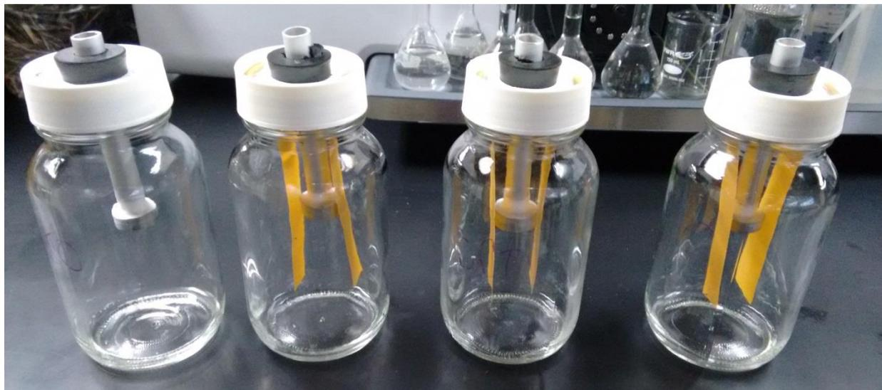
Figura 16. Juego de cámaras para pruebas de habilidad de inhibición de VCI.
