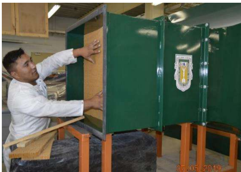
Figura 20. Instalación de honeycomb en cámara estabilizadora.
