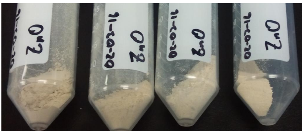
Fig. 10 Muestras de NPs de ZnO molidas, almacenadas y catalogadas.
