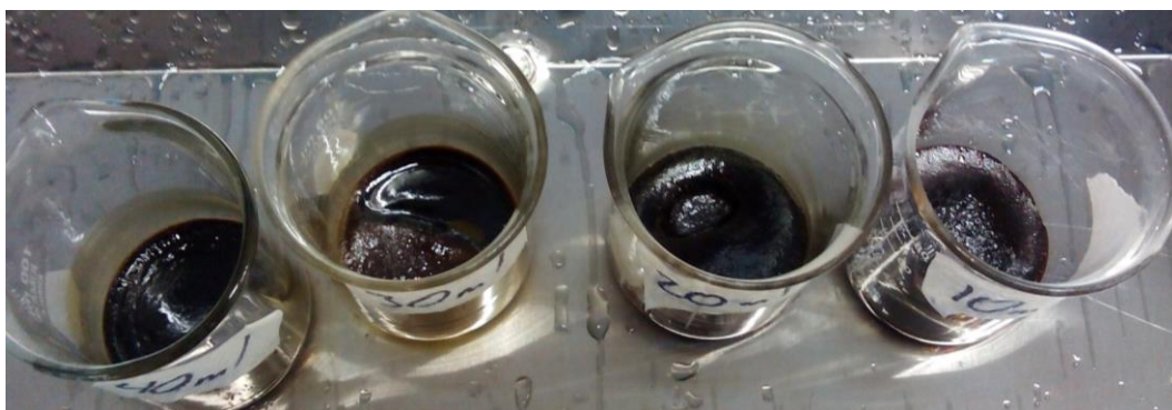
Fig. 8 Mezclas después de la evaporación del agua controlada por el baño maría.
