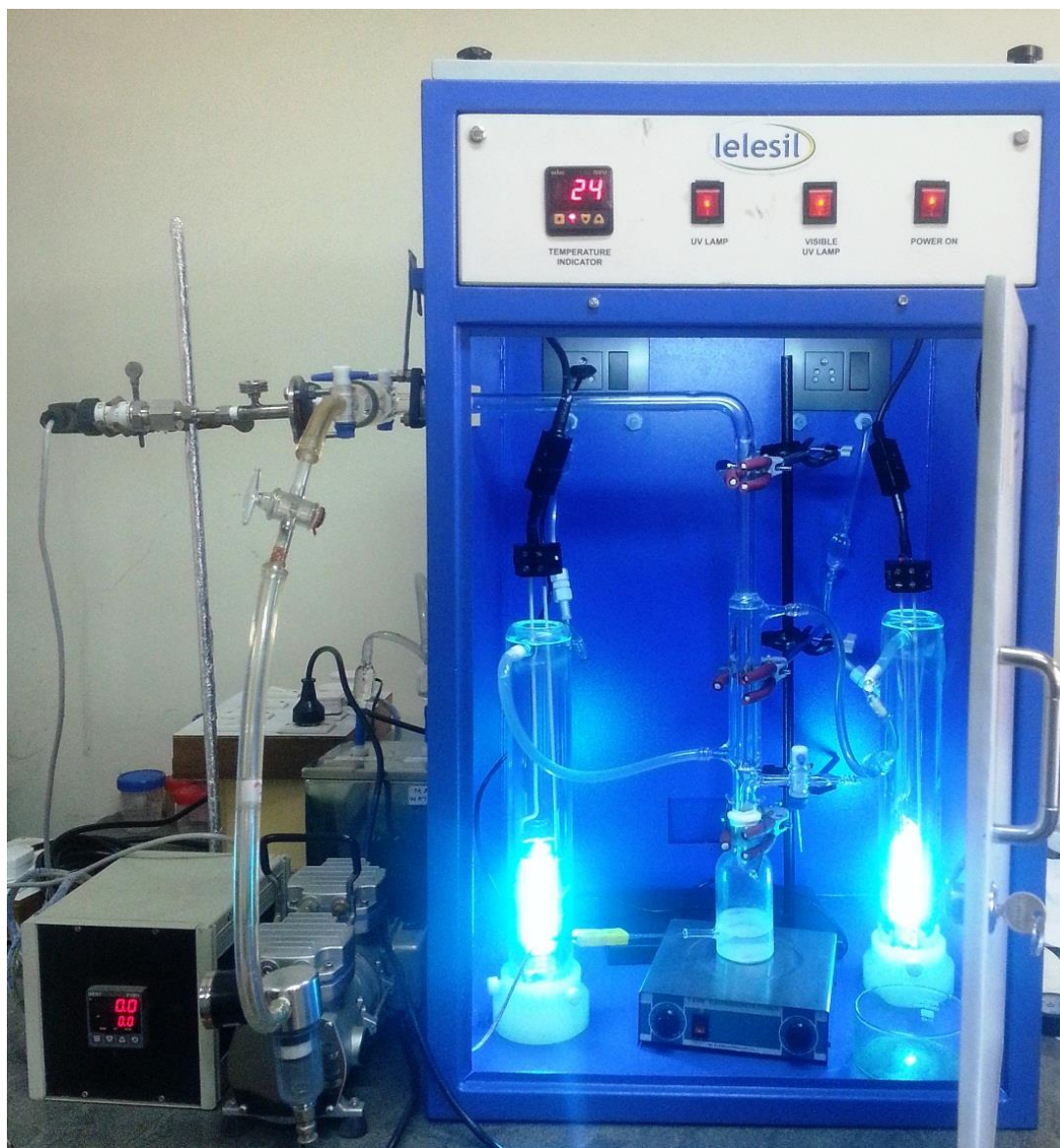
Fig. 12 Aparato de UV utilizado en la prueba de degradación fotocatalítica.
