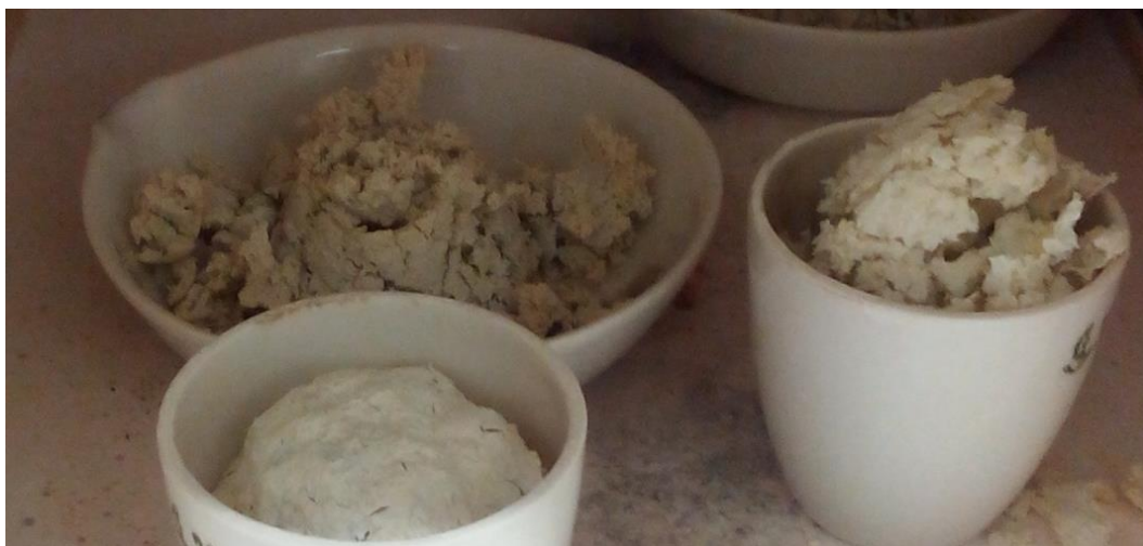
Fig. 9 Muestras dentro de crisoles, después del tratamiento térmico.
