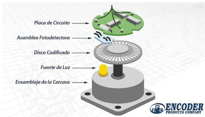
Figura 1.2 Descripción la construcción básica de un encoder rotativo con tecnología óptica (Figura recuperada de [15]).
