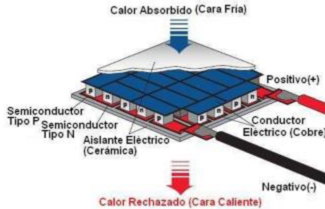
Figura 1.10 Diagrama de estructura interna de una celda de Peltier (figura tomada de [18]).
