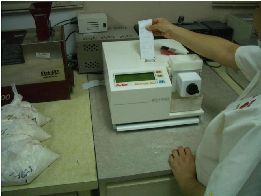
Figura 3. Equipo Per Con Inframatic 8611 utilizado para determinar la proteína en harina
