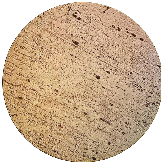
Fig. 3. 14 Microestructura del cobre virgen, vista de la parte superior, 500X.
