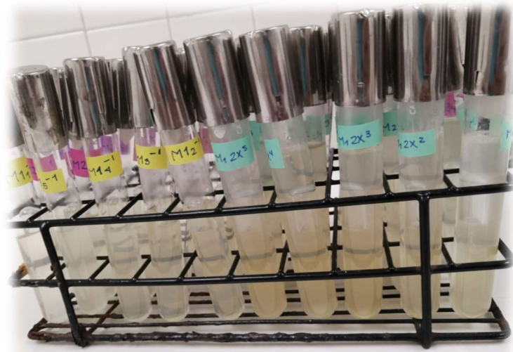
Muestras sembradas en caldo lactosado.
