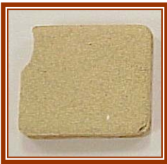
Loseta con CaO sin residuo de anodizado 1100°C/5 Hrs y 900°C/4 Hrs
