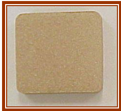
Loseta con MgO sin residuo de anodizado 1100°C/5 Hrs y 900°C/4 Hrs
