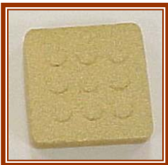
Loseta con CaO con residuo de anodizado 1100°C/5 Hrs y 900°C/4 Hrs
