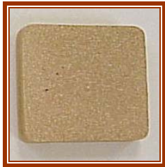
Loseta con MgO con residuo de anodizado 1100°C/5 Hrs y 900°C/4 Hrs
