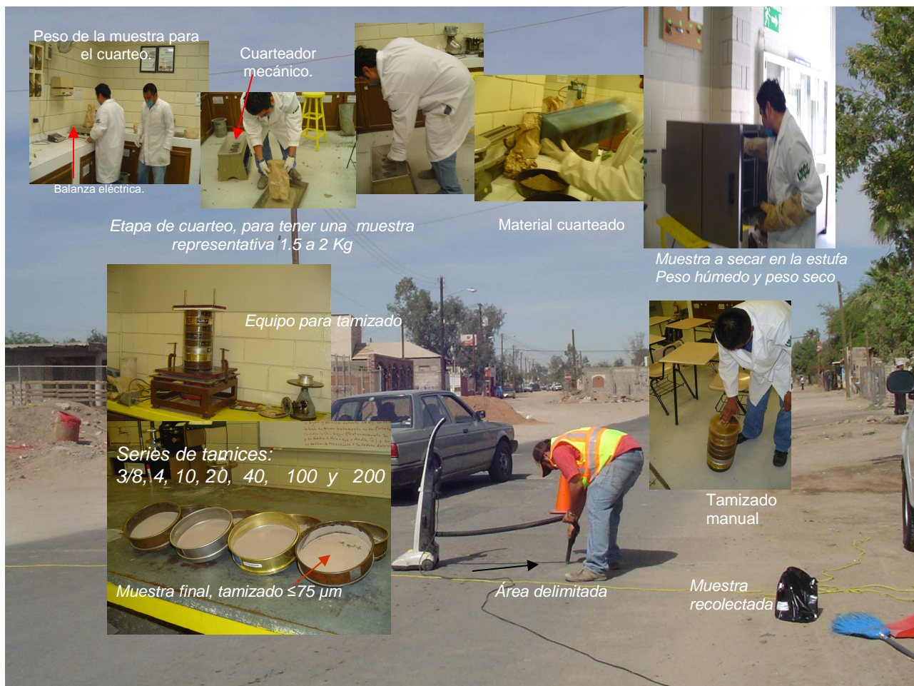
Figura 20.- Etapas principales del análisis vía seca del sedimento recolectado en el laboratorio de resistencia de materiales II, UABC. (Meza, 2008)
