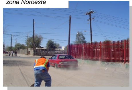
Figura 17.- Recolección de una muestra en una vía no pavimentada y paso peatonal de escolares de primaria, cuya área fue de 30 cm 2 . (Meza, 2008)
