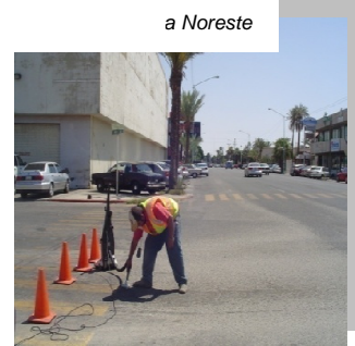
Figura 18.- Recolección de una muestra en una vías pavimentadas en un área de 300 m 2 . (Meza, 2008).
