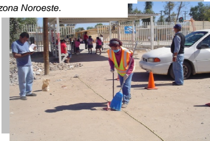
Figura 17.- Recolección de una muestra en una vía no pavimentada y paso peatonal de escolares de primaria, cuya área fue de 30 cm 2 . (Meza, 2008)
