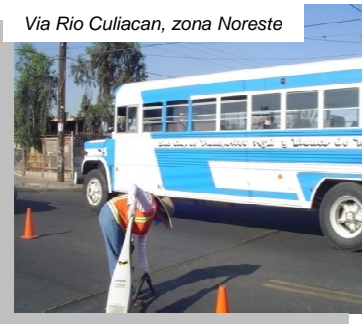
Figura 18.- Recolección de una muestra en una vías pavimentadas en un área de 300 m 2 . (Meza, 2008).
