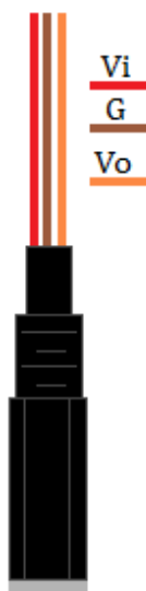
Figura 6. Conexión para el Sensor de Temperatura.
