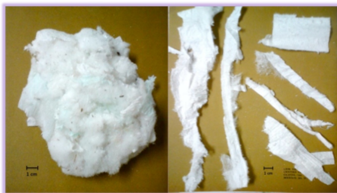
Figura 7-5 Aspecto de la celulosa (izquierda) y del chasis (derecha), del pañal triturado en la astilladora
