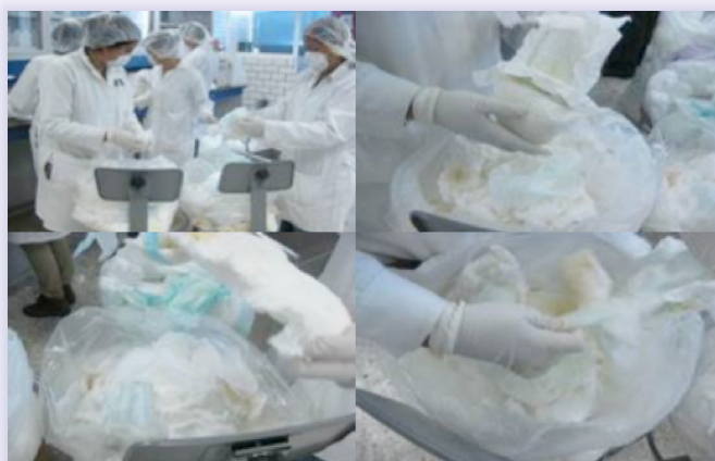
Figura 6-10 Separación manual del plástico de los pañales
