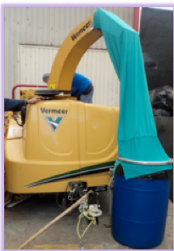
Figura 7-42 Trituradora con adaptador para molienda de pañales
