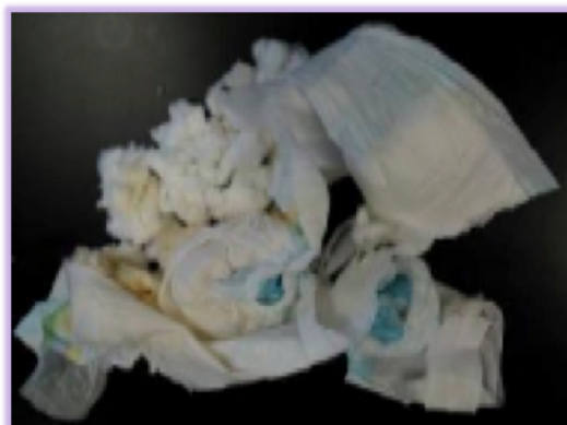
Figura 7-3 Pañal triturado en el molino de martillos
