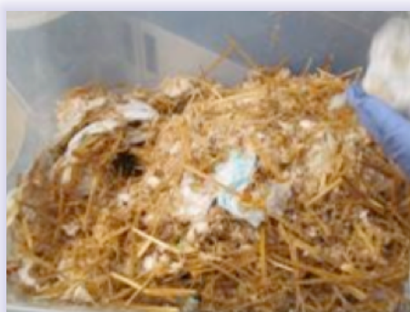
Figura 6-16 Mezclado manual del cosustrato con el pañal
