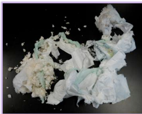
Figura 7-4 Pañal triturado en el molino de aspas
