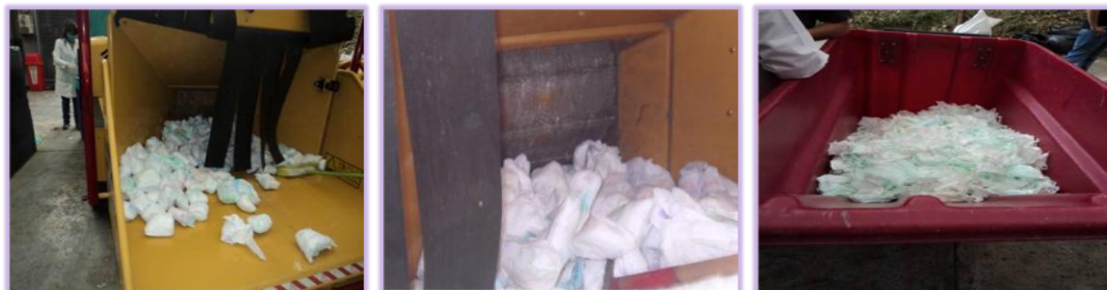
Figura 7-43 Entrada de los pañales al proceso de molienda y pañales triturados
