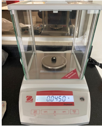
Figura 16. Pesaje de cemento previo a la colocación en caja petri.
