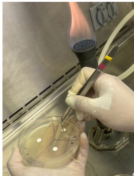
Figura 17. Colocación de los discos con cemento en las cajas petri.
