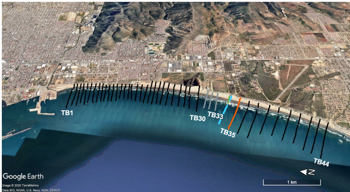
Figura 7.- Vista aérea de la playa de estudio del TB1 al TB30 comprenden la playa Ensenada, del TB34 al TB44 comprenden la playa El Ciprés. Los perfiles TB31 al TB33 en gris, son los perfiles TB interpolados a partir de perfiles batimétricos. El perfil en azul es el TB33 utilizado para analizar el comportamiento de la playa y el TB35 en naranja muestra el perfil al sur del espigón utilizado para los cálculos volumétricos. En verde podemos apreciar la ubicación del espigón temporal.
