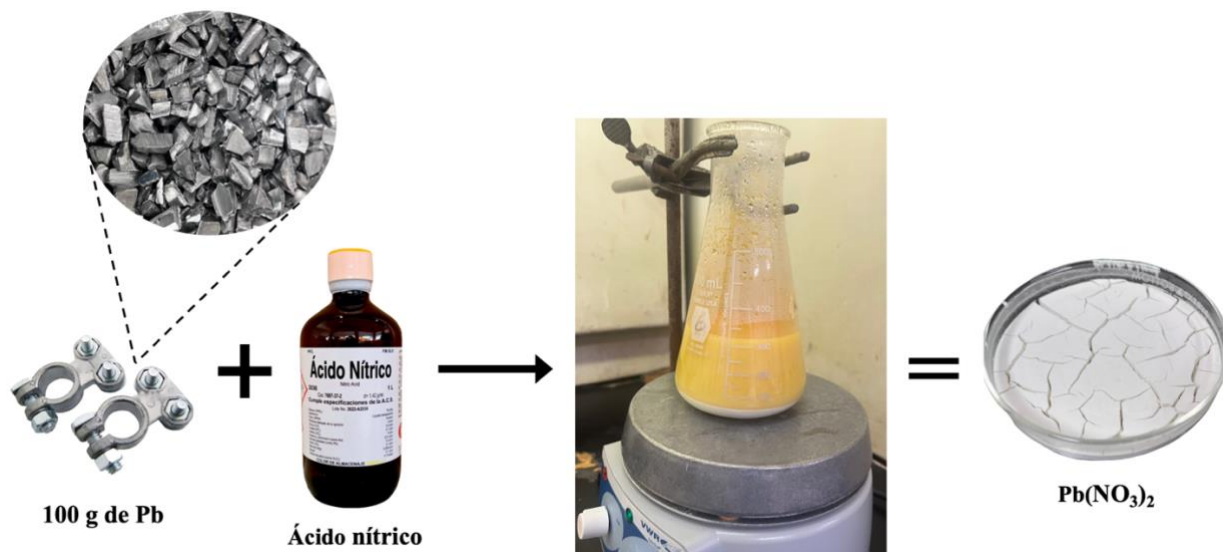
Figura 3. Esquema de reacción para la síntesis de nitrato de plomo a partir de Pb.
