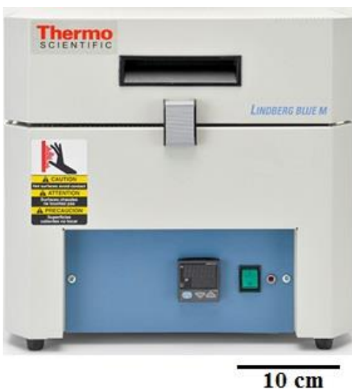
Figura 4. Horno eléctrico marca Lindberg Blue M. con dimensiones de 28 cm de largo, 41 cm de ancho, y 38 cm de alto.
