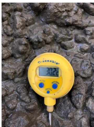
Figura 44. Evaluación de temperatura de concreto en estado fresco.
