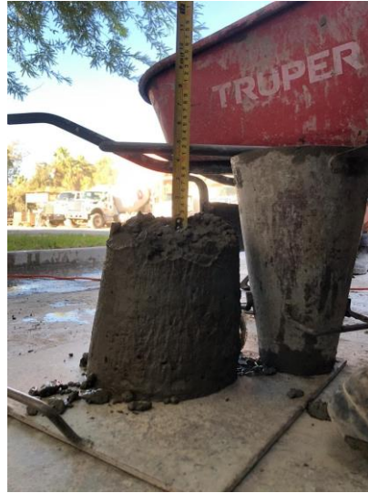
Figura 45. Medición de asentamiento de concreto en estado fresco.
