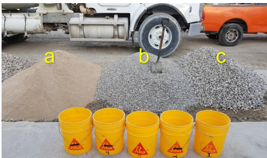
Figura 39. Agregado grueso y fino utilizados: (a) AN, (b) GS y (c) GT.
