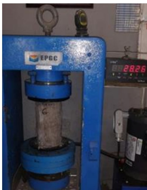
Figura 51. Evaluación de carga máxima en probeta de concreto.
