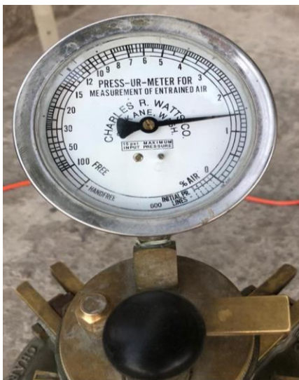
Figura 47. Evaluación de contenido de aire en concreto en estado fresco.
