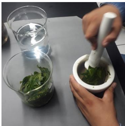
Figura 25. Maceración de hoja de neem con agua destilada.
