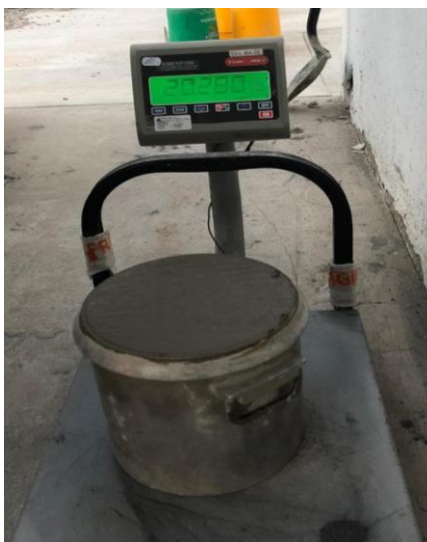
Figura 46. Medición de peso de concreto en estado fresco.
