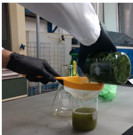
Figura 27. Filtrado del extracto con cedazo.
