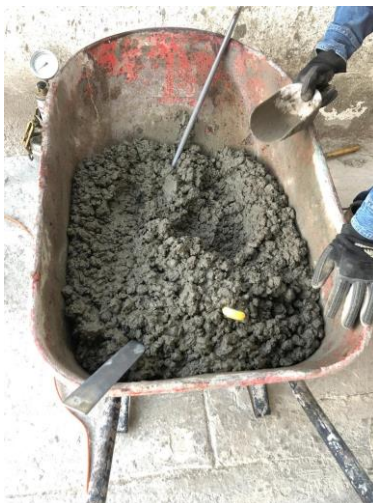
Figura 43. Toma de muestra de concreto.
