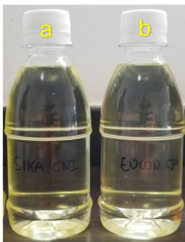
Figura 30. Aditivos inhibidores de corrosión: (a) Sika CNI y (b) Eucon CIA.
