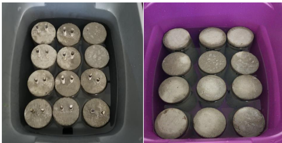
Figura 53. Exposición de probetas ambiente salino (3.5% NaCl).
