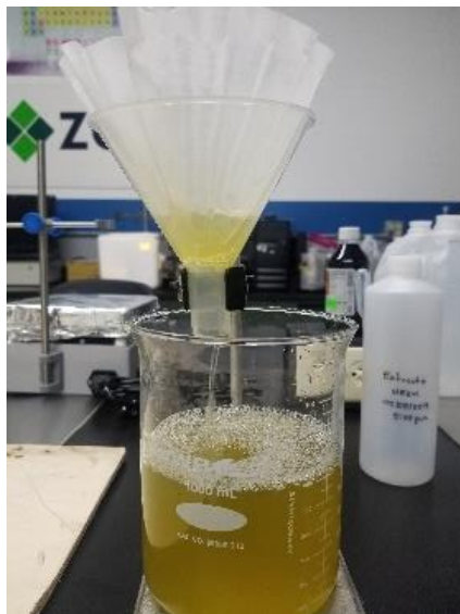
Figura 28. Filtrado del extracto con papel filtro.
