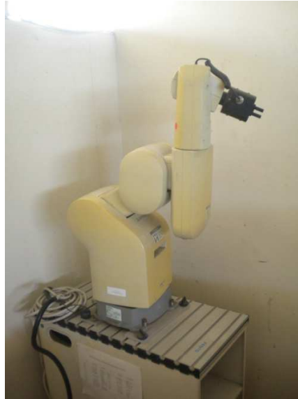
Figura 20. Robot manipulador Mitsubishi RV-E2.
