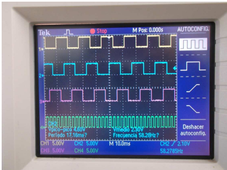
Figura 31. Señales de salida circuito divisor de frecuencia.
