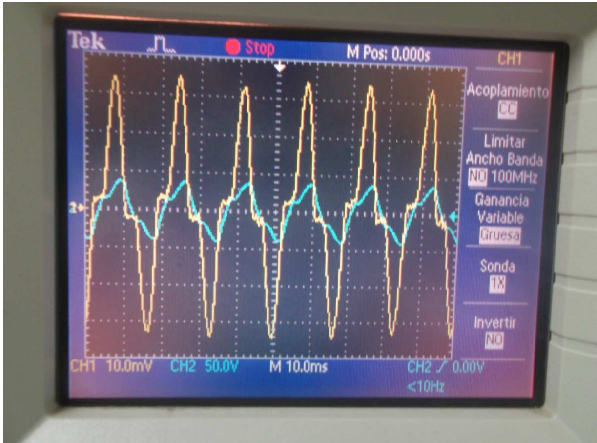
Figura 44. Señales de voltaje y corriente, fuente de alimentación.
