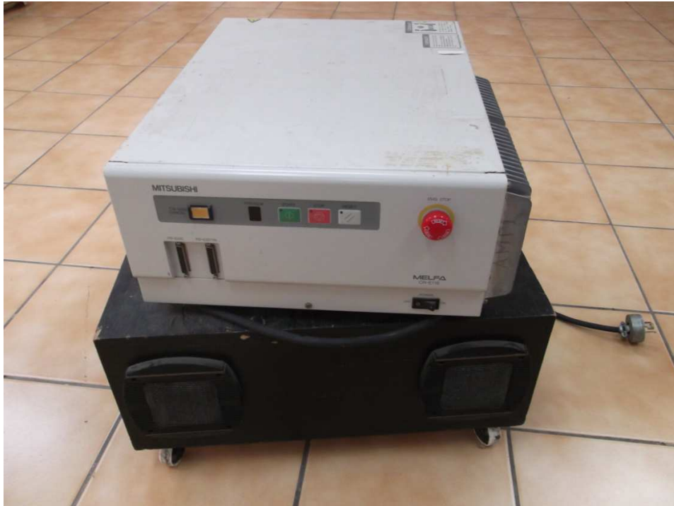
Figura 21. Controlador CR-E116 de Mitsubishi.
