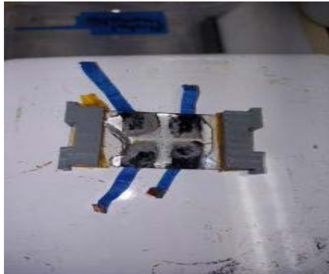
Figura (A12) . Celda fotovoltaica con cableado en electrodo y encapsulada con resina.
