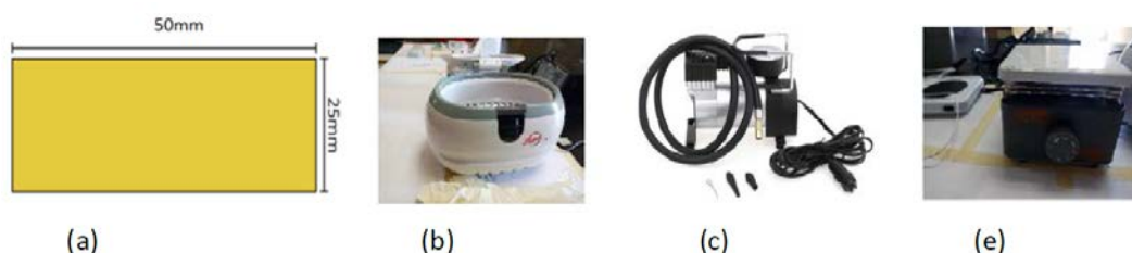
Figura A1. (a) Sustrato vidrio/ITO, (b) olla ultrasónica, (c) compresor de aire, (e) plancha calefactora.
