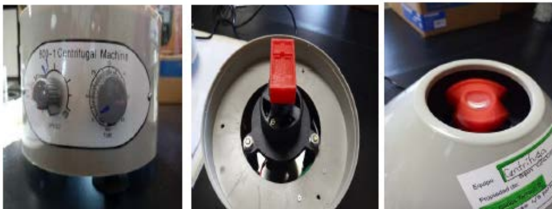
Figura 4.9. Olla 800-1 Centrifuga Machine, Max Velocidad 4000 r/min. Fuerza Relativa de Centrifugado ( RCF ) 1790xg. Y Timer. Con base modificada para sustrato.
