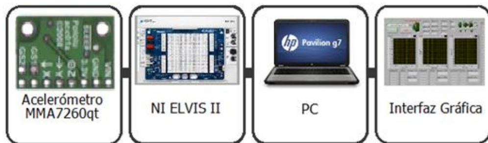
Fig. 3-1 Diagrama a bloques de sistema con acelerómetro.
