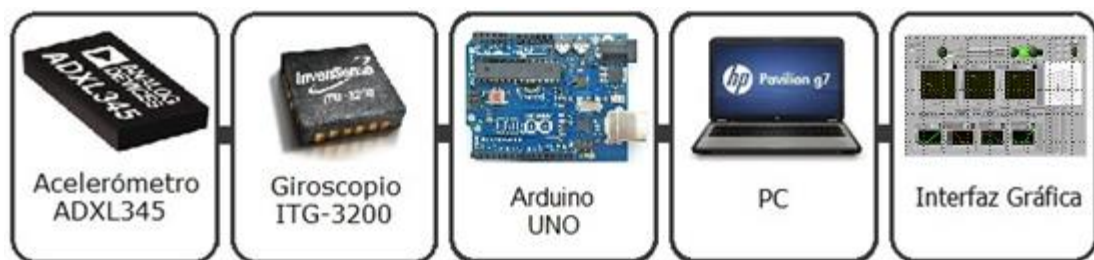
Fig. 4-1 Diagrama a bloques de sistema de detección de movimientos específicos.
