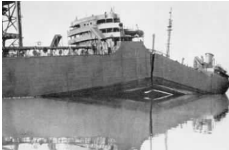
Figura 1.6 Falla por fractura del buque S.S. Schenectady (1944).
