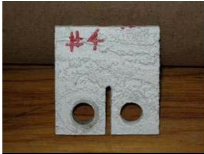
Figura 4.14 Espécimen atacado por la salmuera geotérmica
