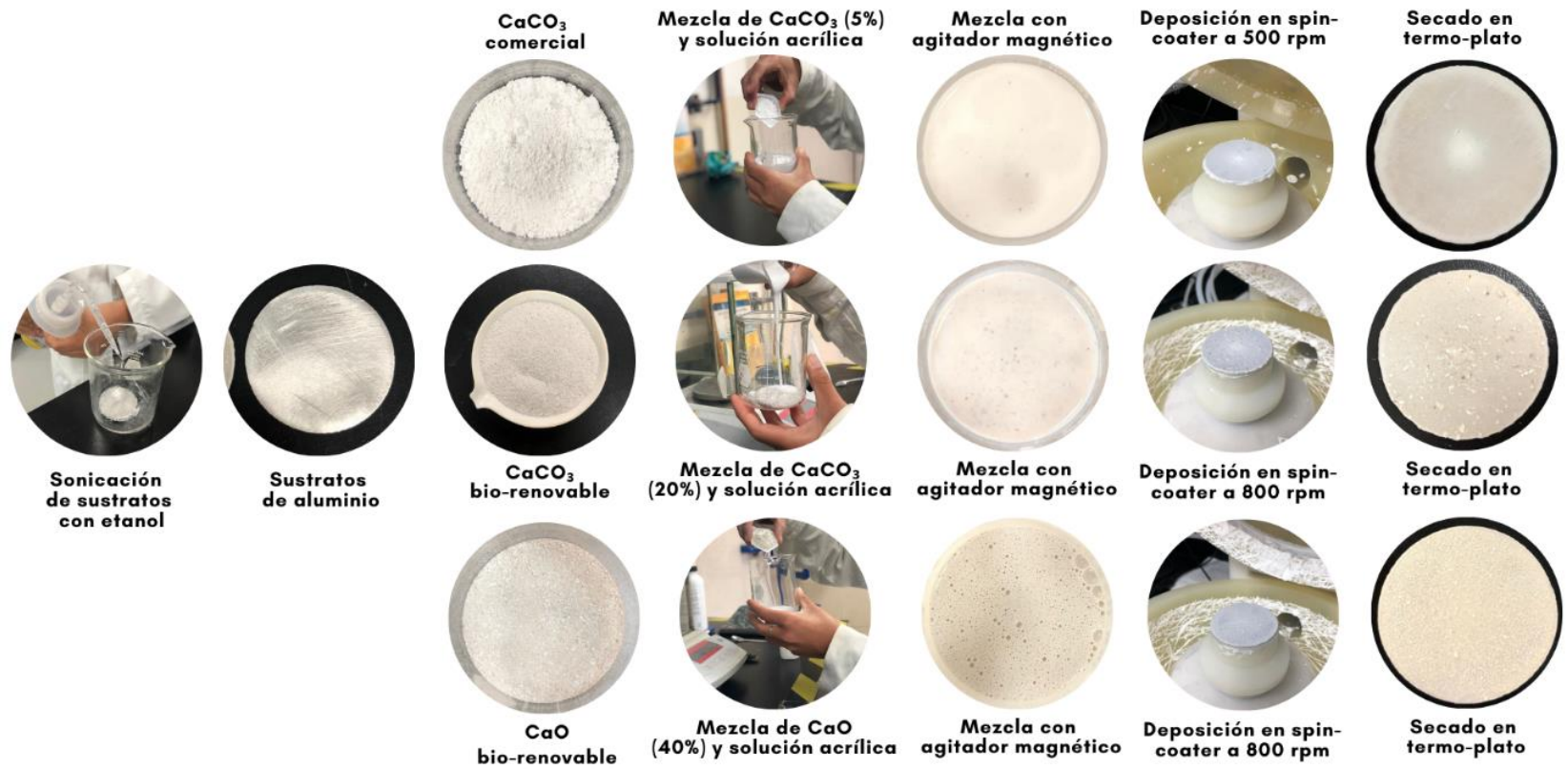
Figura 29 Prueba piloto para la fabricación de muestras prototipo
