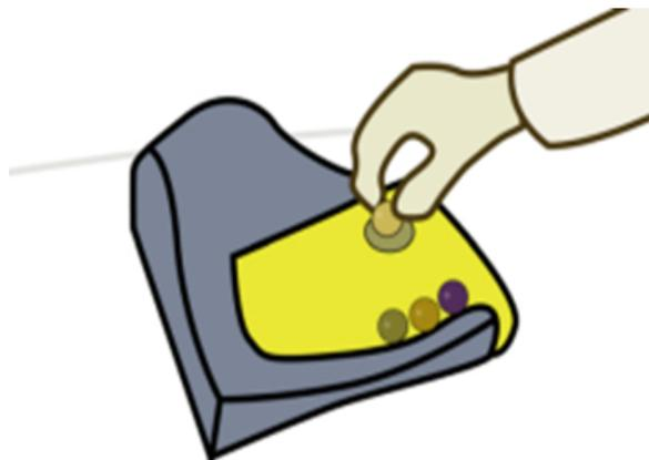
Figura 5.7: La máquina contestadora de canicas utiliza canicas para identificar e interactuar con los mensajes (imagen tomada de [Klemmer et al., 2004]).
