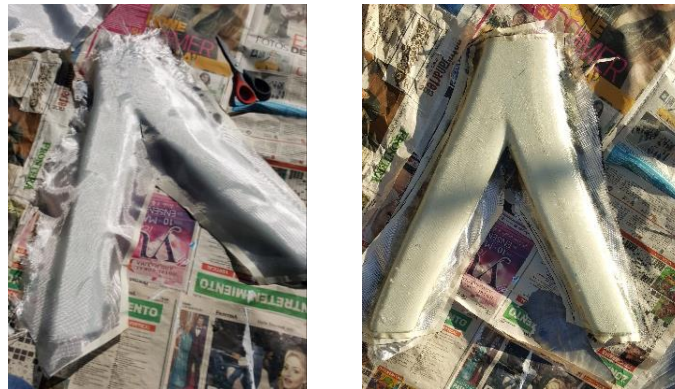
Figura 3.40. Modelo de MDF, (a) colocación de fibra de vidrio, (b) aplicación de resina.
