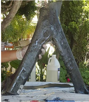
Figura 3.54. Modelo al finalizar la aplicación de fibra de carbono y resina epóxica.
