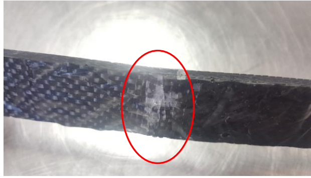
Figura 3.16. Fractura en probeta.
