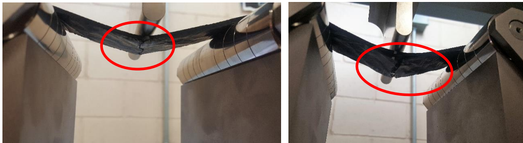
Figura 3.15. De laminación en probeta (a) zona de prueba (b) acercamiento a zona de de laminación.
