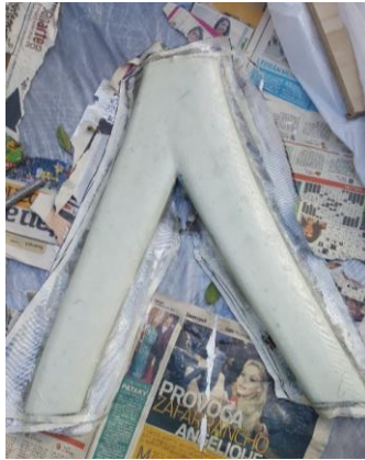
Figura 3.41. Molde de fibra de vidrio curado.
