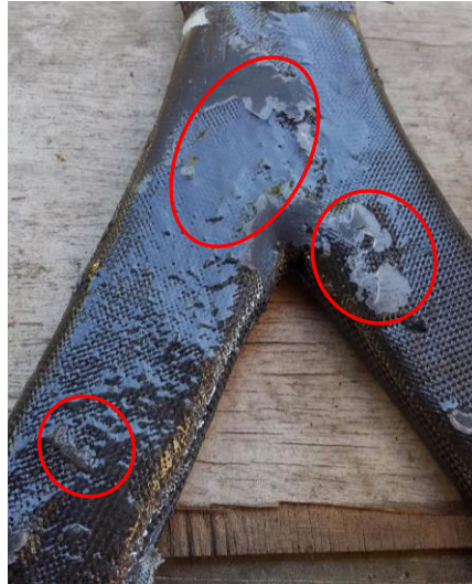
Figura 4.3. Excedente de resina en el prototipo a causa del molde.
