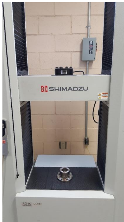
Figura 3.9. Máquina de pruebas universales de precisión Shimadzu AG-IC 1000 kN. (Shimadzu, 2018).
