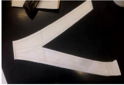
Figura 3.23. Unión de plano y superficie de cartón para una mayor rigidez.
