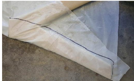
Figura 3.49. Colocación de plástico sobre modelo.
