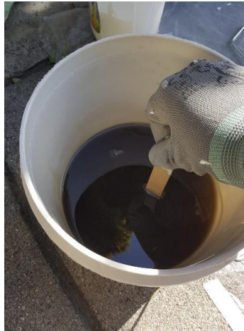
Figura 3.39. Mezcla de resina y secante.
