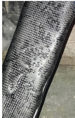
Figura 4.4. Superficie del prototipo posterior al proceso de lijado.
