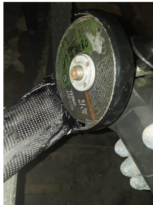
Figura 3.58. Recorte de excedentes en la pieza.
