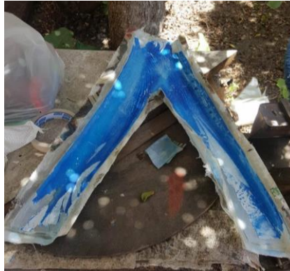
Figura 3.43. Molde lijado con superficie uniforme.
