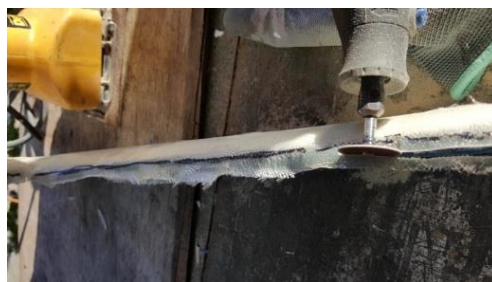
Figura 3.45. Remoción de material sobrante en el molde.
