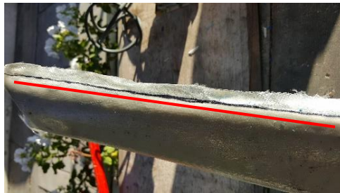
Figura 3.44. Delineado de bordes con marcador.
