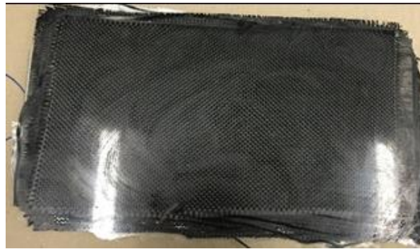
Figura 3.6. Vista posterior del laminado final.
