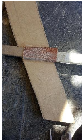
Figura 3.28. Pieza de MDF en proceso de lijado.
