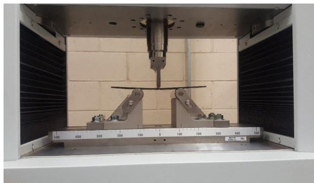
Figura 3.13. Probeta colocada para ensayo de flexión.
