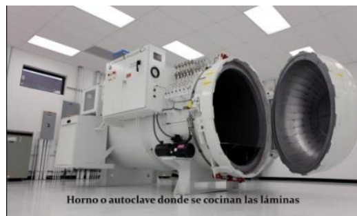
Figura 1.6. Horno autoclave utilizado para curado de resina. ( carbon concrete. 2008 ).
