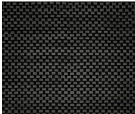
Figura 3.3. Fibra de carbono 3K utilizada para la fabricación de la horquilla.
