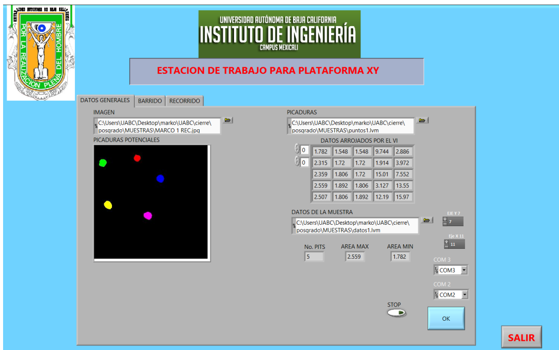
Figura 3.7 Interfaz del usuario para la estación de trabajo con movimiento XY.
