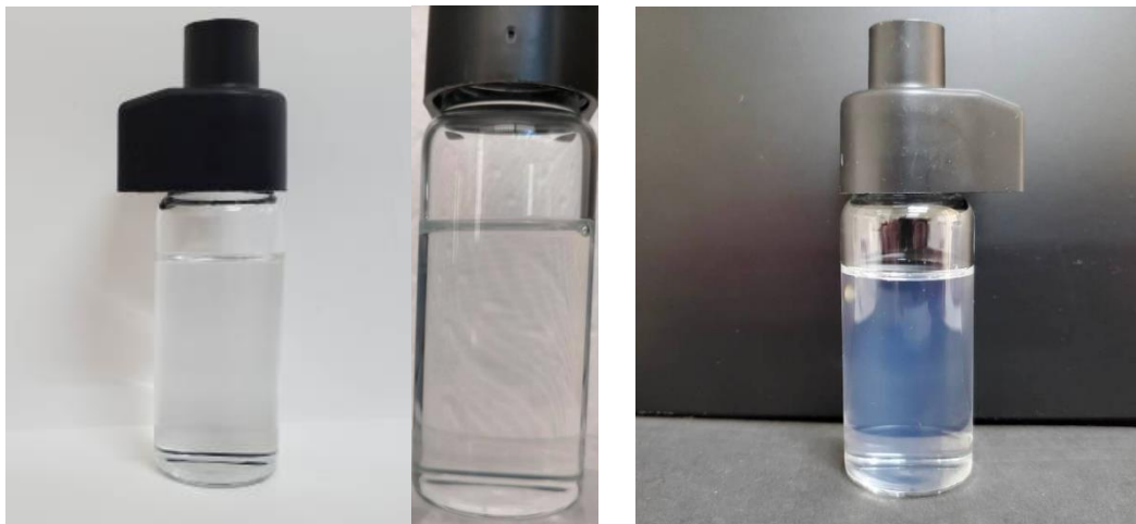
Figura 17. (Izq.) Formulación NEE13 contra una superficie blanca. La nanoemulsión no mostró separación de fase o perturbación en la inspección visual, y se observaba altamente transparente. (Der.) La luz natural atravesando la emulsión permitía observar una ligera coloración azul.
