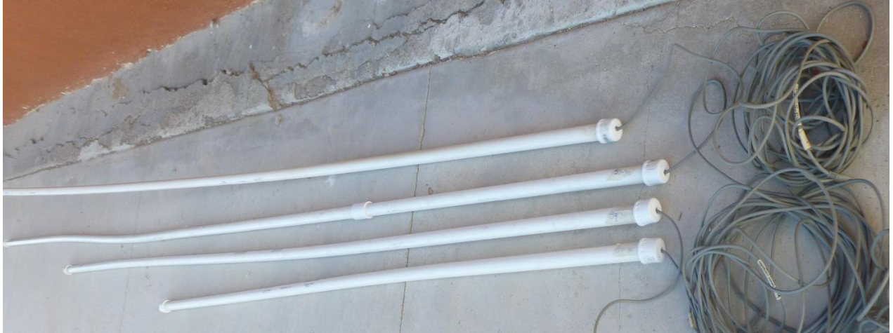
Figura 21. Sonda con sensores de temperatura para monitoreo en el subsuelo de Puertecitos.
