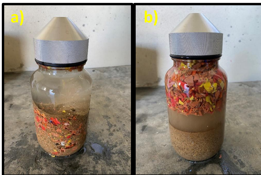
a) Plástico HDPE asentado en la arena y b) Plástico HDPE flotando.
