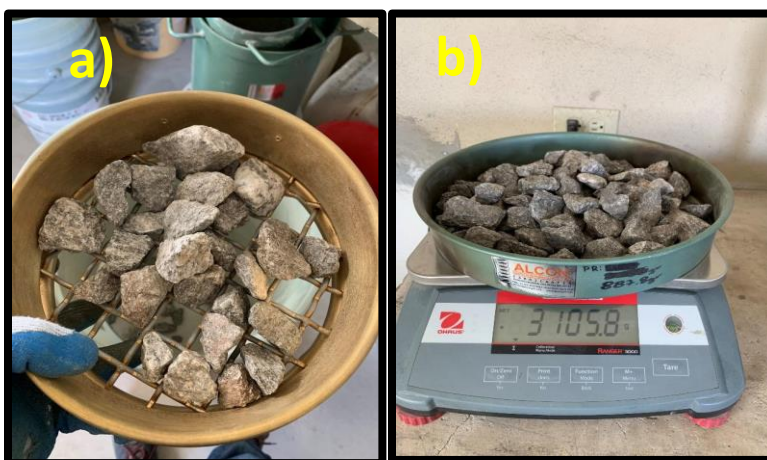
a) Cribado de la grava de 40 mm, b) Pesado de la grava de 40 mm retenida
