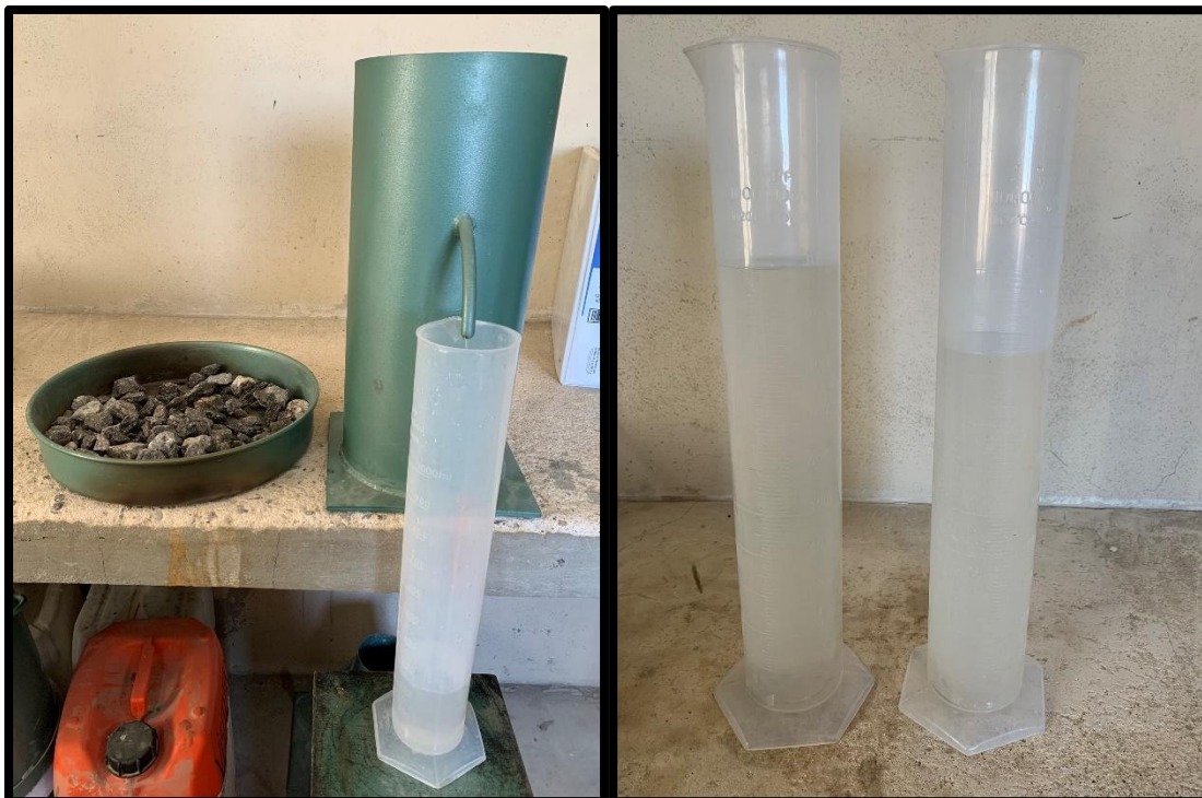
Figura 28. Determinación de la densidad del agregado grueso de 40 mm.
