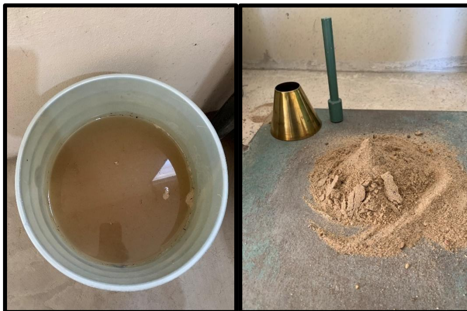
Figura 29. Preparación del agregado fino en estado S.S.S.
