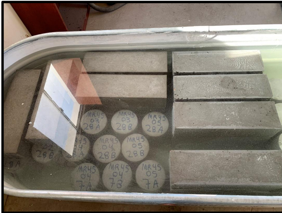
Figura 40. Curado de especímenes
