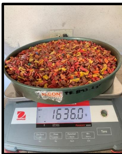
Figura 25. Pesado del plástico HDPE retenido de 10 mm.
