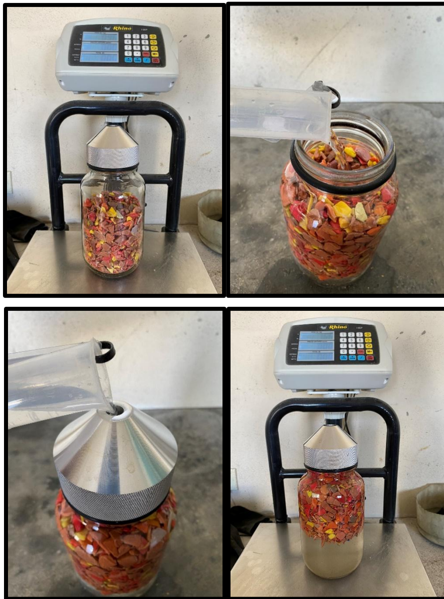
Figura 31. Determinación de la densidad del plástico HDPE como agregado fino.
