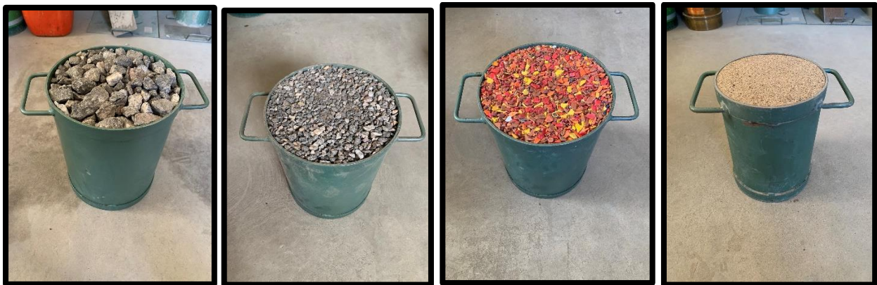
Figura 35. Ensayo de peso volumétrico de los agregados.
