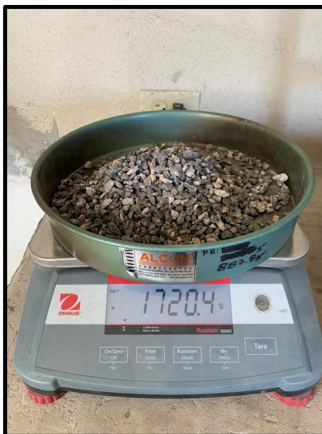
Figura 19. Pesado de la grava retenida de 10 mm.
