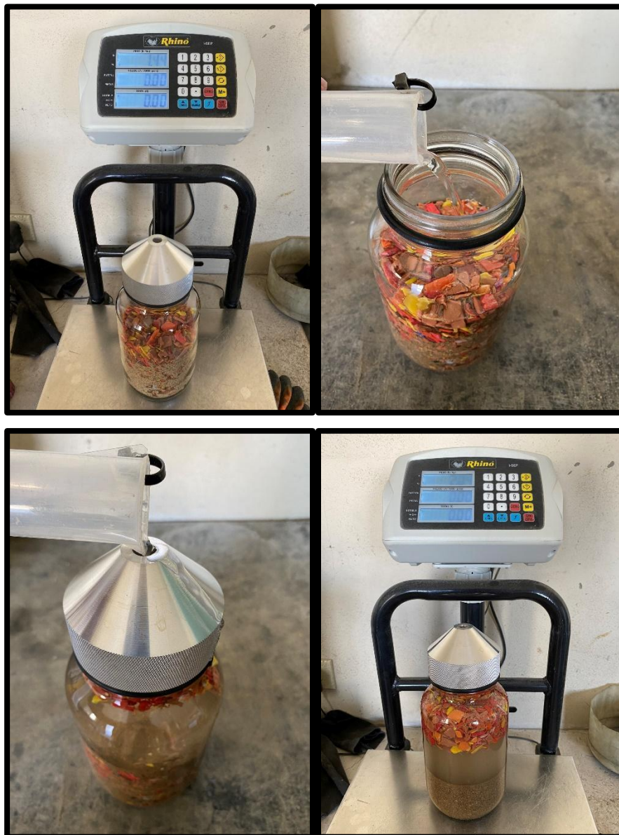
Figura 33. Determinación de la densidad de la arena con plástico HDPE.
