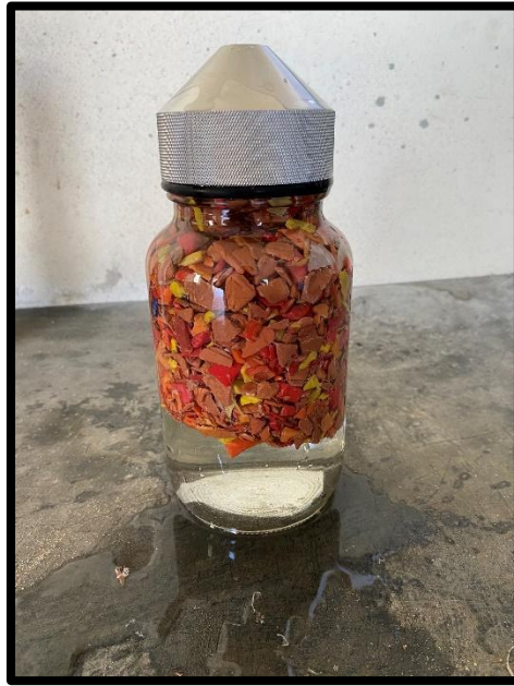
Figura 32. Efecto de flotación del plástico HDPE en agua.
