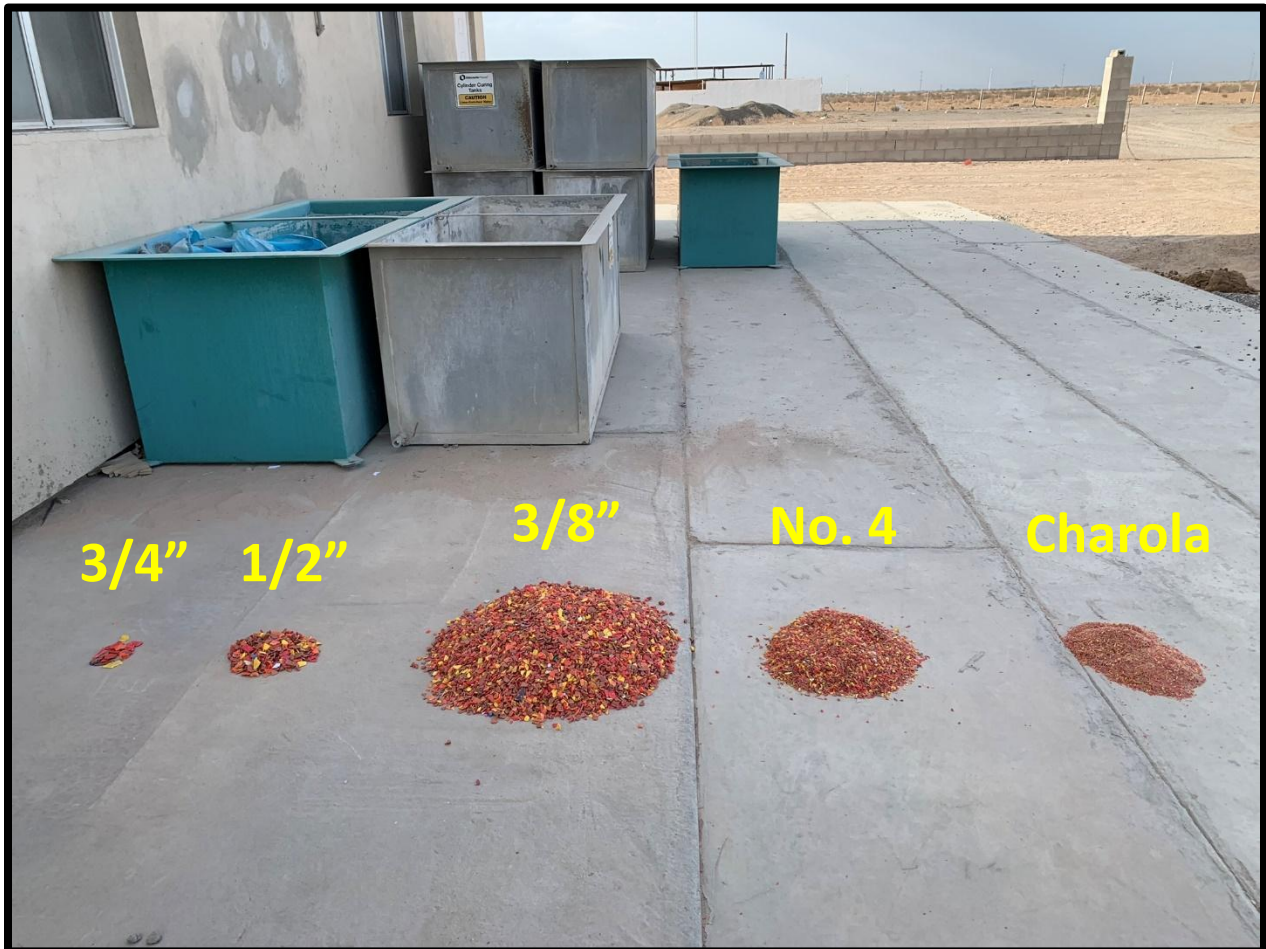
Figura 26. Ilustración de la distribución granulométrica del plástico HDPE.
