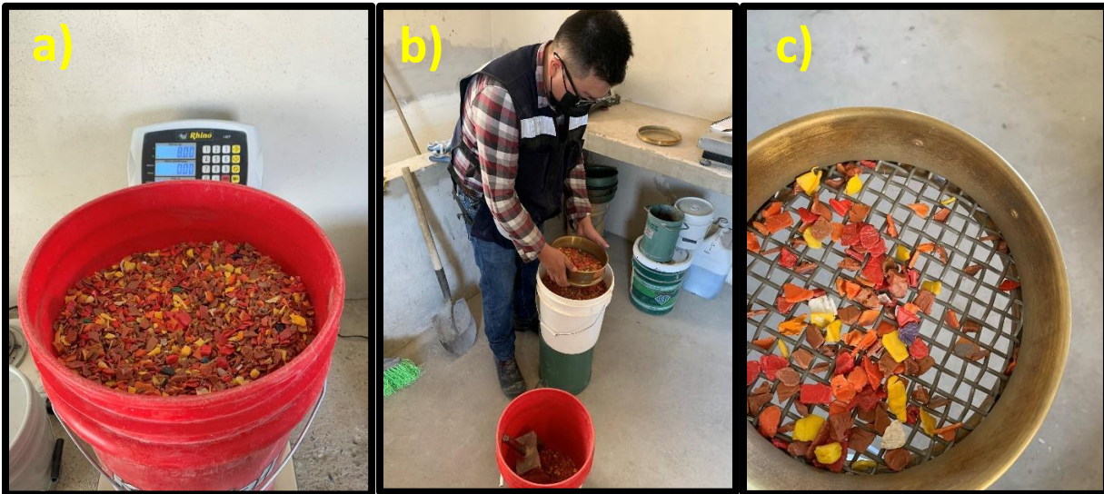
a) Muestreo, b) Cribado del plástico HDPE y c) plástico HDPE retenido.
