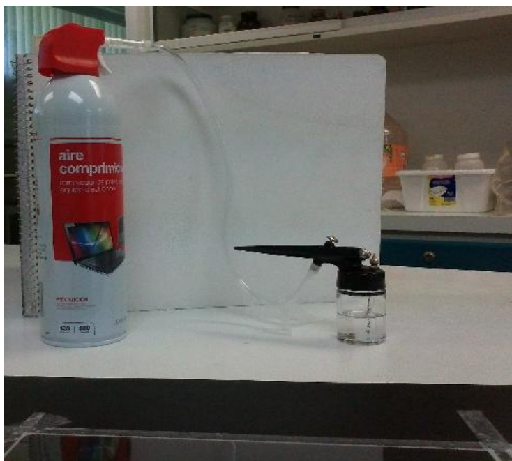
Figura 4. Equipo para aspersión de fase estacionaria en placas de vidrio y láminas de PET.
