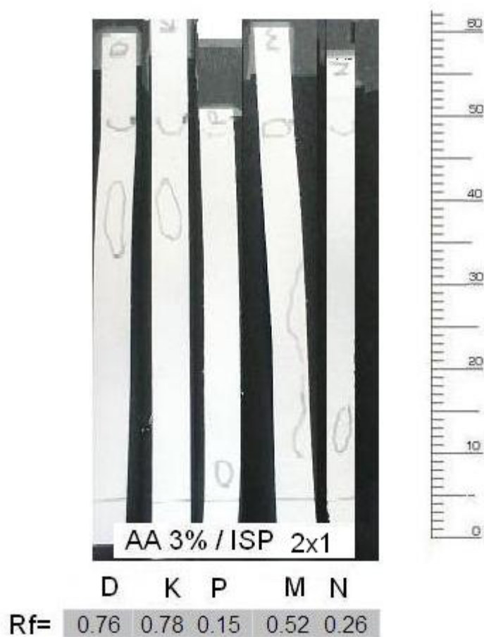
Figura 26. Se muestra un monitoreo de productos de reacción en el que se usa AA 3% / ISP 2x1 como fase móvil.
