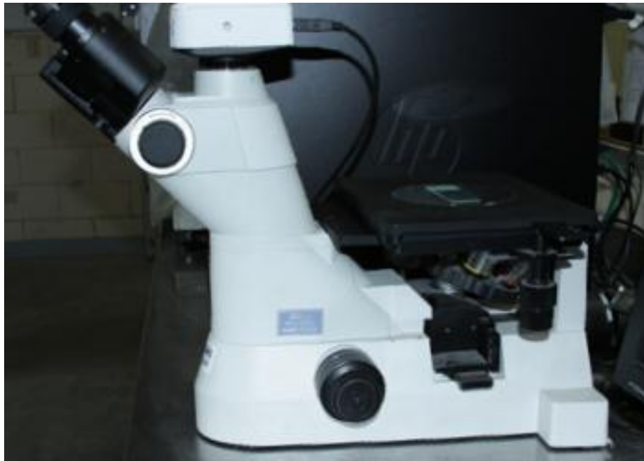
Figura 8. Microscopio metalográfico invertido Nikon Eclipse MA 100.
